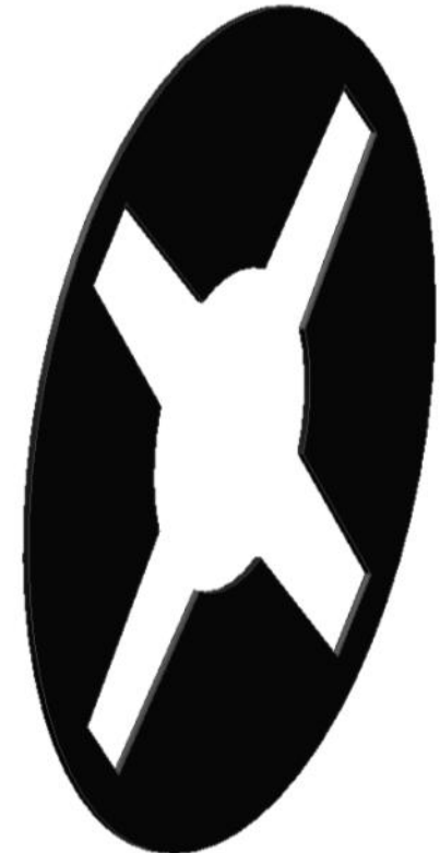
Wicklungsträger (Glasfaser) herzustellen im Auflege- und Laminierverfahren
