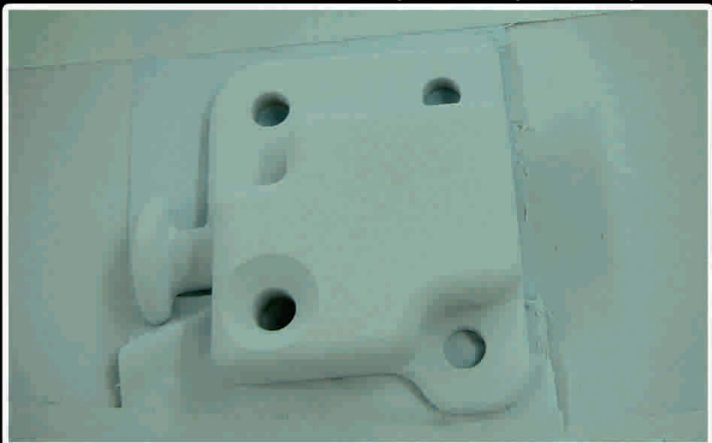
Pomalowane gniazdo zasilania anteny. Widać charakterystyczną fakturę farby. Faktura ta utrudnia niepożądane odbicia światła.
