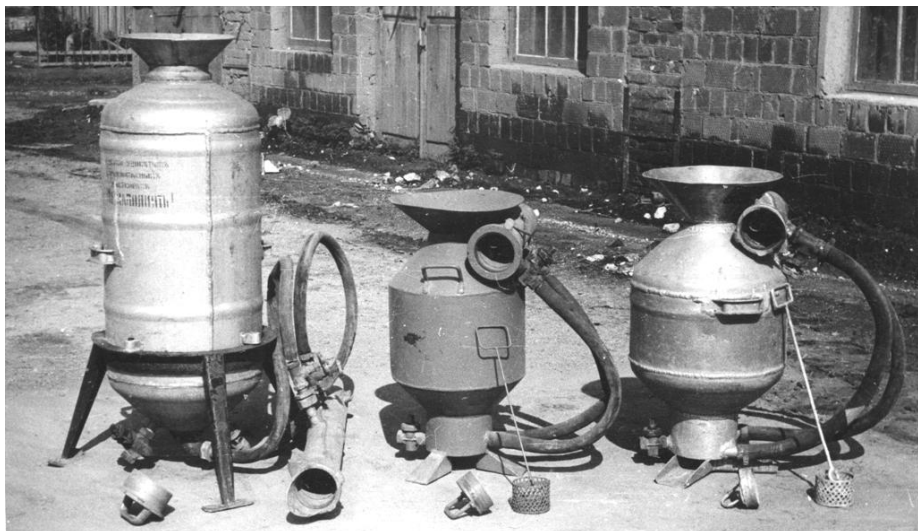
Рисунок 3 – Гидроподкормщик к дождевальным машинам позиционного действия: УДВ-06С (замена), экспериментальный образец (НИИОХ) и серийный ГПД-50 (Котельниковский завод с/х машиностроения)
