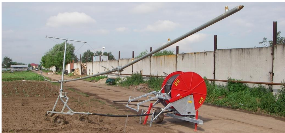
Рисунок 16 – Дождевальная машина барабанного типа с металлической фермой и короткоструйными насадками
