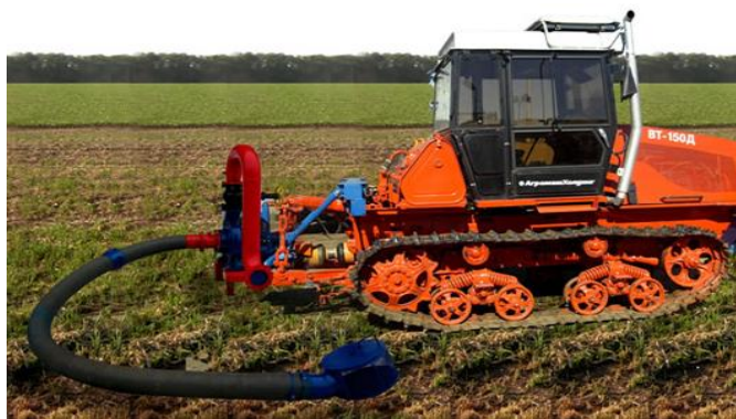
Рисунок 5 – Навесная насосная станция
