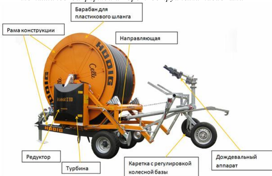
Рисунок 17 – Дождевальная машина барабанного типа с дальнеструйным дождевальным аппаратом
