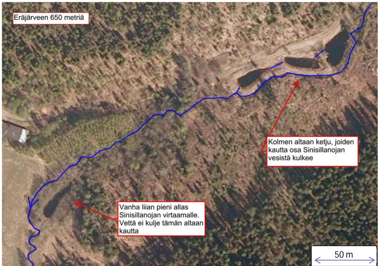
Kuva 7.16. Sinisillanojan allasketju ilmakuvasa. Valtaosa Sinisillanojan vesimäärästä ohittaa altaat tällä hetkellä. Altaiden kunnostuksella saataisiin Eräjärveen Sinisillanojasta kohdistuvaa kuormitusta pienemmäksi. (Pohjakartta © Maanmittauslaitos lupa nro 65/MML/12.)
