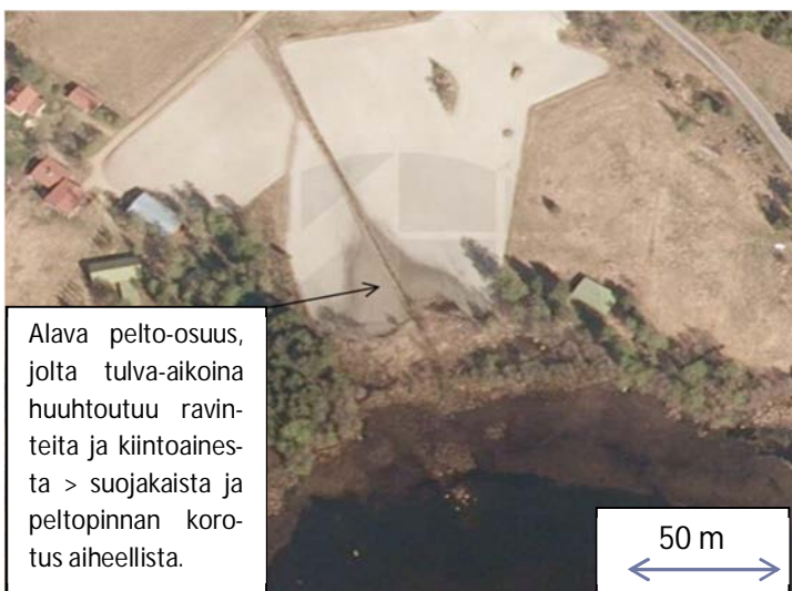
Kuva 7.23. Alavalta, herkästi vettyvältä pelto-osuudelta irtoaa tulvavesien mukana runsaasti ravinteita Eräjärveen. Kolmikouranojassa fosfaattifosforin pitoisuus 9.5.2012 oli korkea 73 µg/l. (Pohjakartta © Maanmittauslaitos lupa nro 65/MML/12.)
