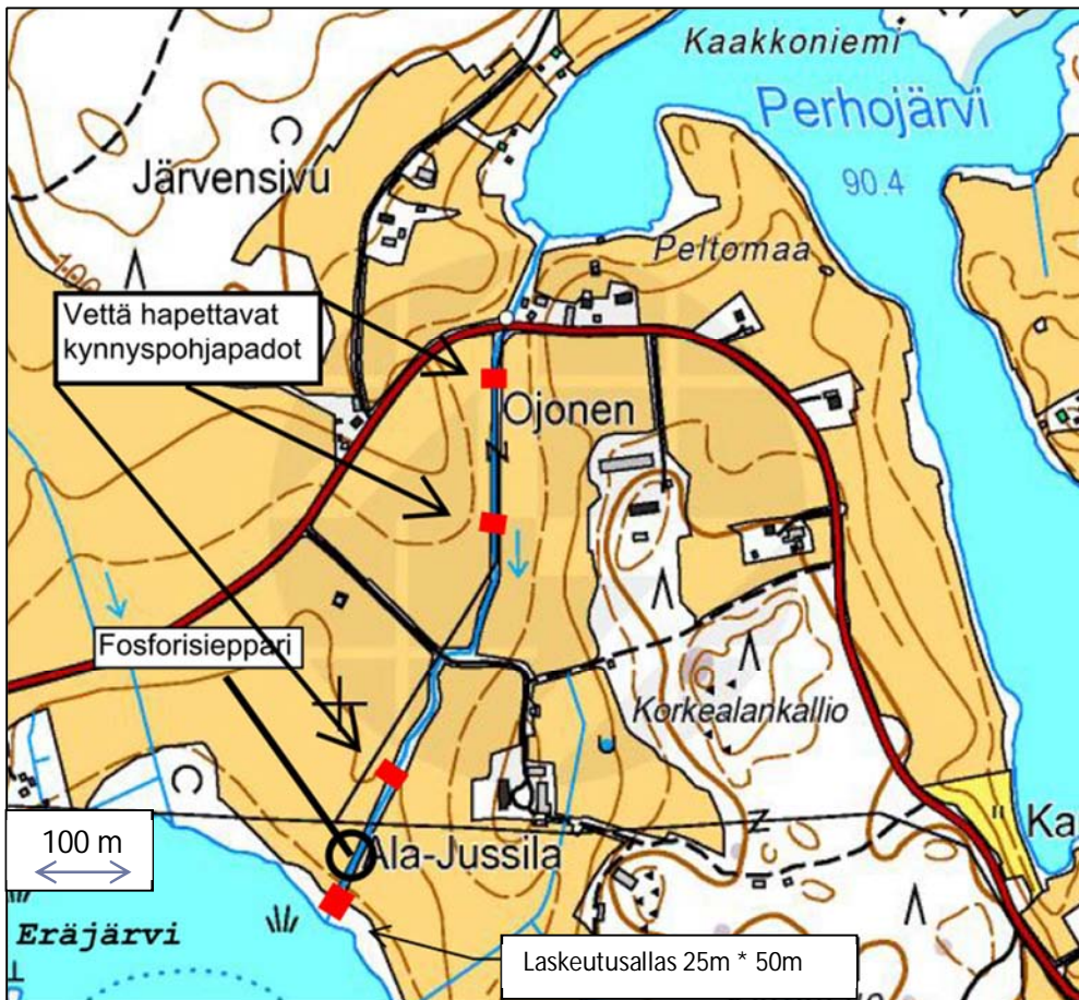
Kuva 7.24. Perhojärvenojaan on mahdollista asentaa fosforisieppari. Fosforisiepparin alapuolelle tehtävä laskeutusallas toimisi siepparissa saostuneen fosforin varastotumisaltaana. Perhojärven vesi on Eräjärven veteen nähden puolet ravinteikkaampaa. Vettä hapettavien pohjapatojen sijoituspaikat on selvitettävä vielä tarkemmin. (Pohjakartta © Maanmittauslaitos lupa nro 65/MML/12.)
