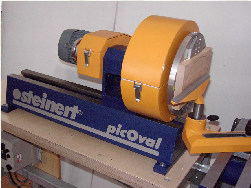
Figure 3406 Ovalturning lathe picOval (Drechselzentrum Erzgebirge Steinert ®, 2006)
