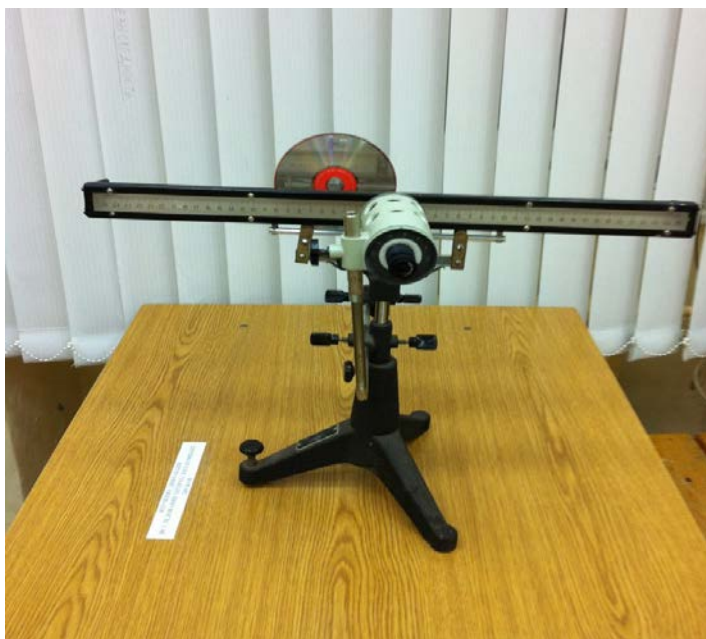
Рис. 3. Установка для исследования дифракции на диске
