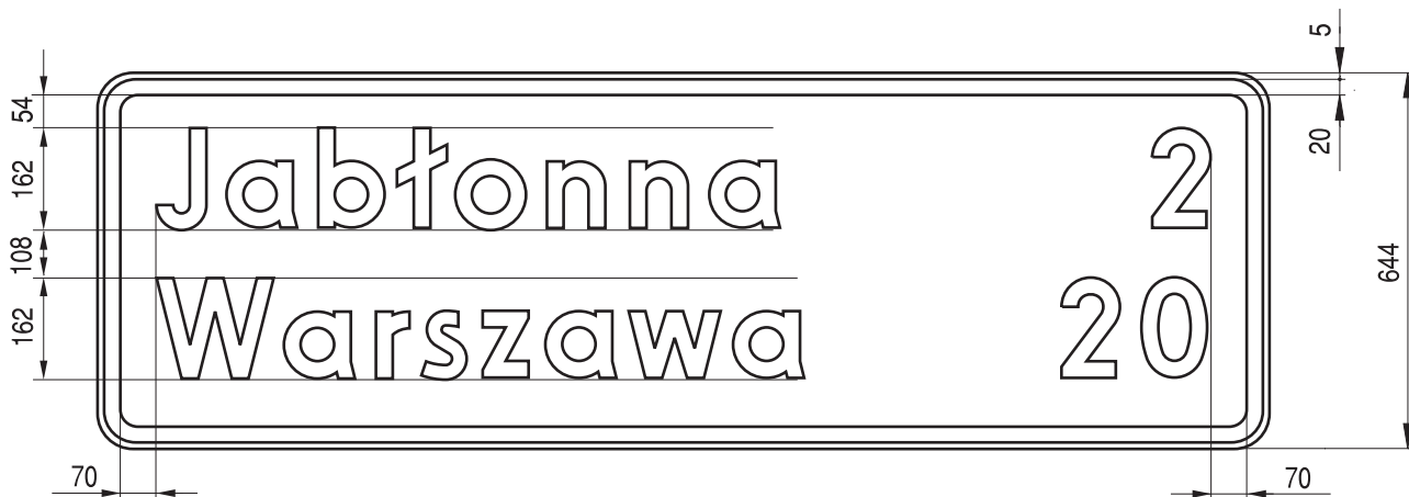
Rys. 9.5.43. Konstrukcja znaku E-13
