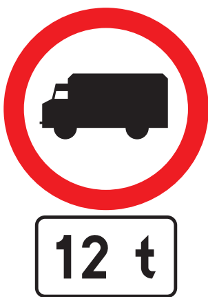
Rys. 3.2.6.3. Znak B-5 z tabliczką podającą masę pojazdu
