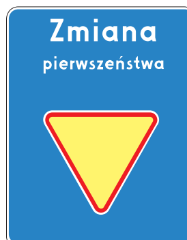
Rys. 5.2.54.2. Znak D-48 wskazujący wlot podporządkowany
