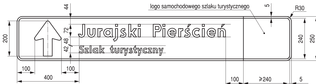
Rys. 9.5.54. Konstrukcja znaku E-22a
