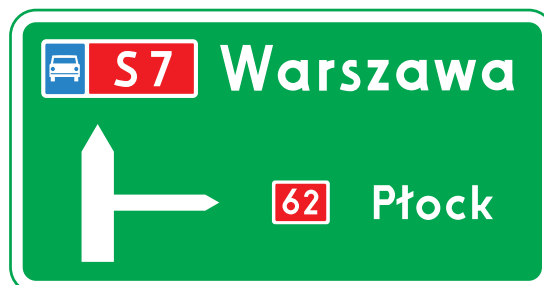
Rys. 6.3.1.7. Tablica E-1 na początku drogi ekspresowej
