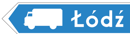
Rys. 7.2.13.2. Znak F-13 wskazujący przejazd tranzytowy do miejscowości
