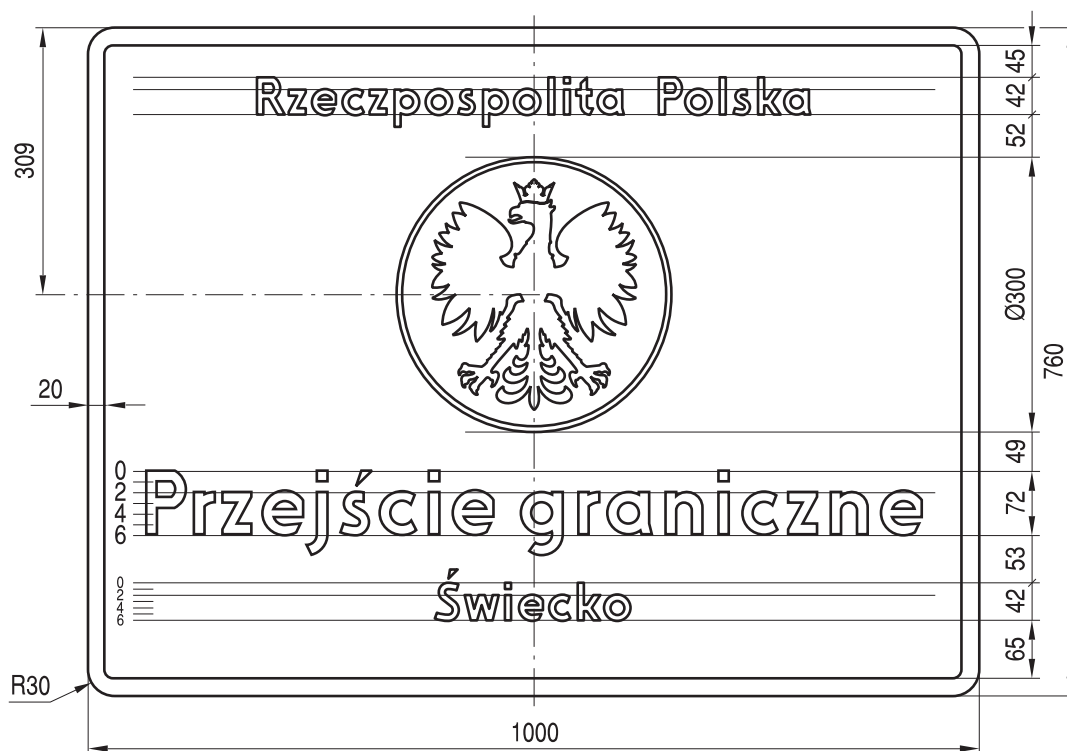
Rys. 9.6.1. Konstrukcja znaku F-1
