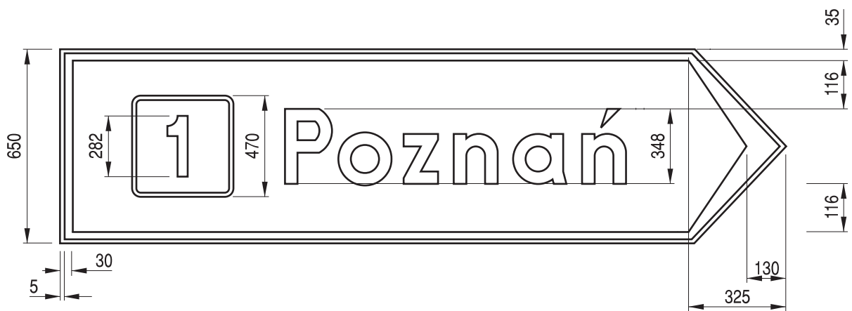
Rys. 9.5.24. Konstrukcja znaku E-3
