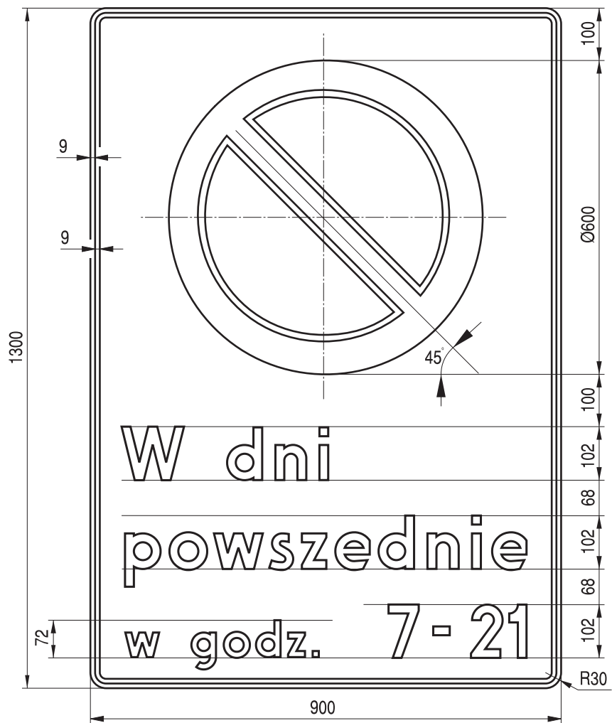
Rys. 9.2.47. Konstrukcja znaku B-39
