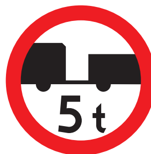
Rys. 3.2.8.2. Znak B-7 podający masę przyczepy
