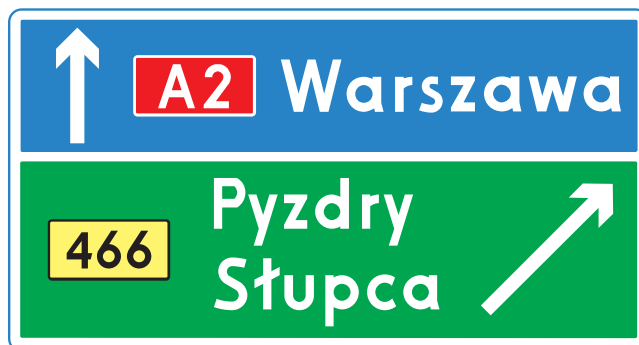
Rys. 6.3.2.5. Drogowskaz E-2c na autostradzie
