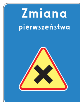
Rys. 5.2.54.1. Znak D-48 wskazujący skrzyżowanie dróg równorzędnych
