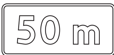
Rys. 9.7.23. Konstrukcja tabliczki T-21 (szczegóły wg rys. 9.7.1)
