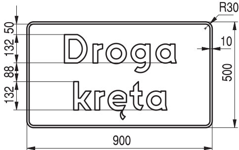
Rys. 9.7.5. Konstrukcja tabliczki T-5
