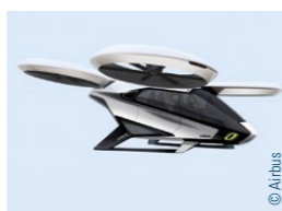
Darstellung des CityAirbus-Konzeptes: ein flügelloses, viersitziges, elektrisches VTOL-Flugzeug Rendering of the CityAirbus concept: a wingless, four-seater, electric, next-gen VTOL vehicle
