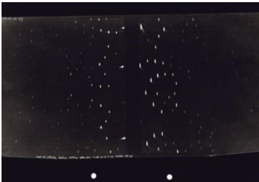
Fig. 2. Primer Nivell del Difractograma de Weissenberg del mateix cristall
