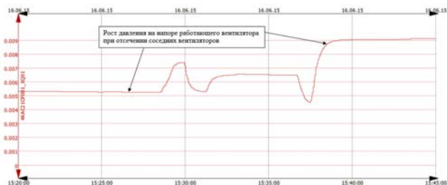
Рис. 6. Рост давления на напоре при дозакрытии арматуры
