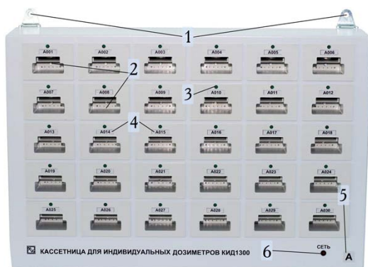
Рис. 7. Внешний вид блока хранения, где 1 – петля для крепления; 2 – ячейка с электрозамком; 3 – индикатор открытия электрозамка; 4 – шифр ячейки; 5 – серия блока; 6 – индикатор питания блока для хранения дозиметров
