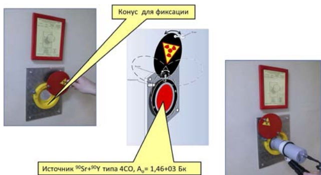
Пример размещения контрольного бета источника для оперативной проверки работоспособности переносных приборов РК (Украина)
