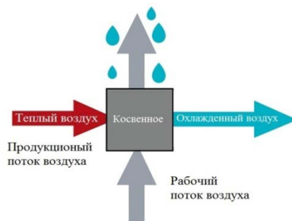
Рис. 1. Схема распределения потоков воздуха
