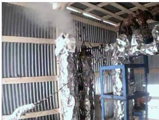
Рис. 8. Эксперимент с разрывом трубок
