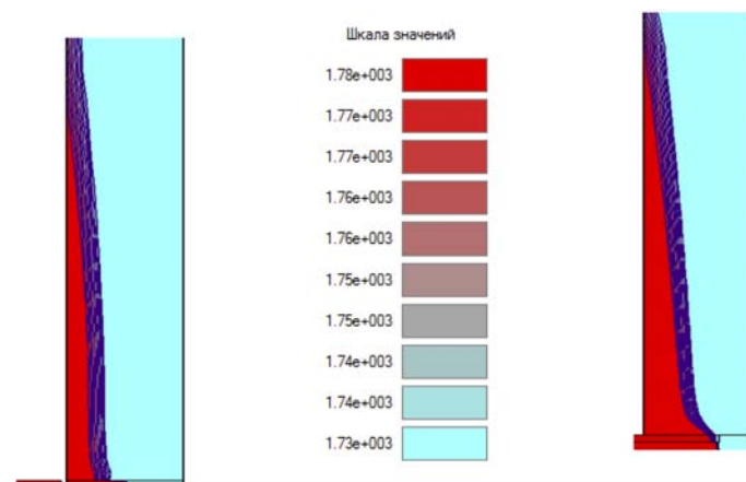
Рис. 8. Распределение стационарной температуры в расчете по лучевой модели
