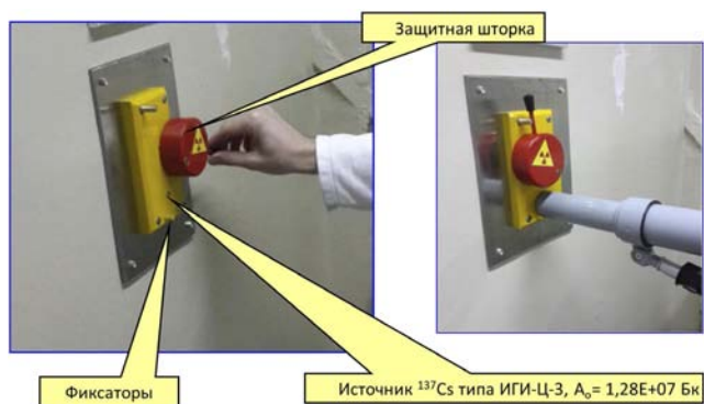
Пример размещения контрольного гамма источника для оперативной проверки работоспособности переносных приборов РК (Украина)
