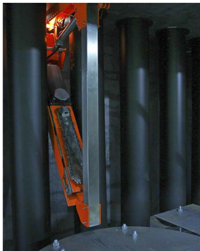
Рис. 6. Высадка роботов на поверхность кожуха реактора. Фото со стенда.
