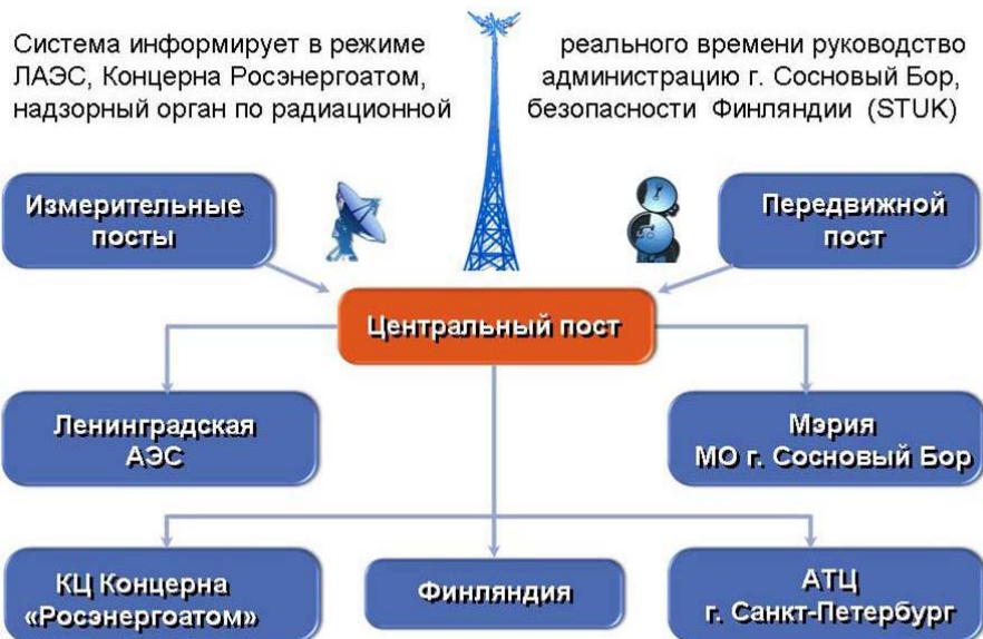
Рис. 12. Схема автоматизированной системы радиационного контроля
