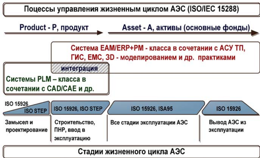
Рис. 5. Схема взаимодействия процессов и IT средств на различных стадиях управления жизненным циклом сложных объектов
