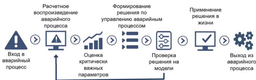
Рис. 5. Схема применения ПТК ВЦАЭС для расчетной поддержки Кризисного центра в случае возникновения аварийной ситуации на энергоблоке АЭС
