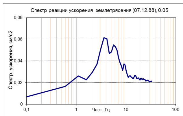
Рис. 6. Запись ускорения Спитакского землетрясения (07.12.88), уровень -3.6м, Y-компонент, ОСП-акселерометр и спектр реакции
