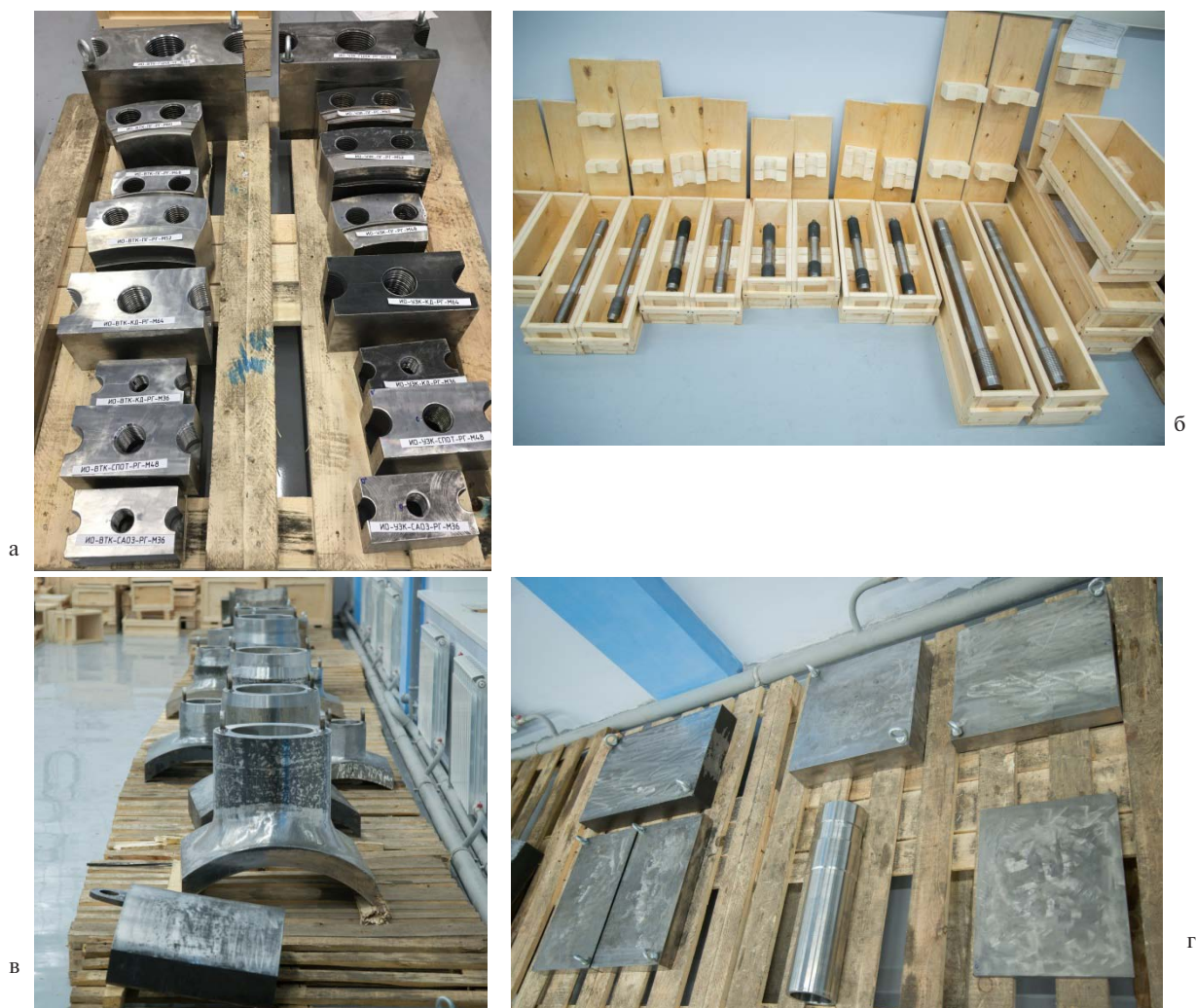
Рис. 2. Испытательные образцы с дефектами для аттестации систем и методик неразрушающего контроля: а – фланцевые разъёмы; б – шпильки; в – угловые сварные соединения и сегмент ГЦТ; г – чехол привода СУЗ и элементы корпусного оборудования РУ
