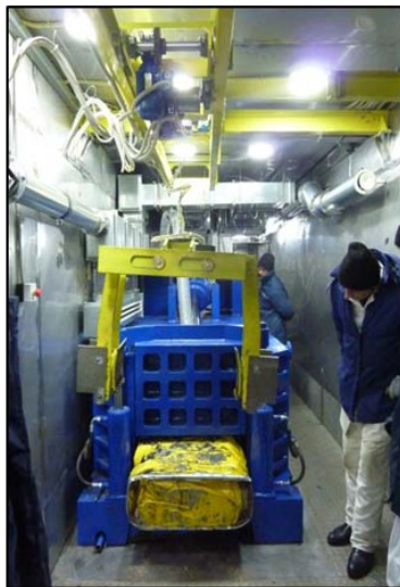
Рис. 2. Компактирование 200-л бочки с ТРО: А — камера пресса с открытой крышкой; Б — камера пресса с закрытой крышкой (прессование 1 ступени); В — загрузка ТРО в камеру пресса; Г — выгрузка брикета после двухосного прессования; Д — перемещение брикета в контейнер КМЗ (за биологической защитой)
