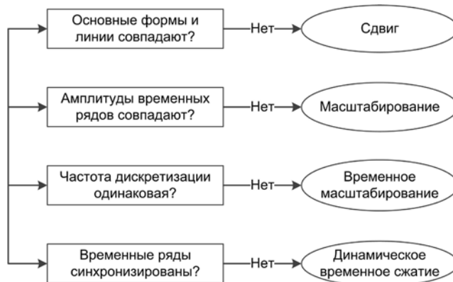
Рис. 3. Дерево решений для выбора преобразования временных рядов
