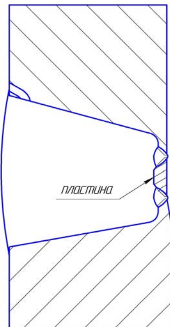
Рис. 5. Отремонтированное сварное соединение по оптимизированной технологии
