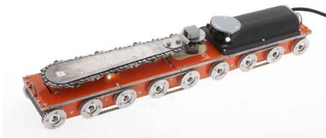
Рис. 4. Робот-углорез в транспортном положении
