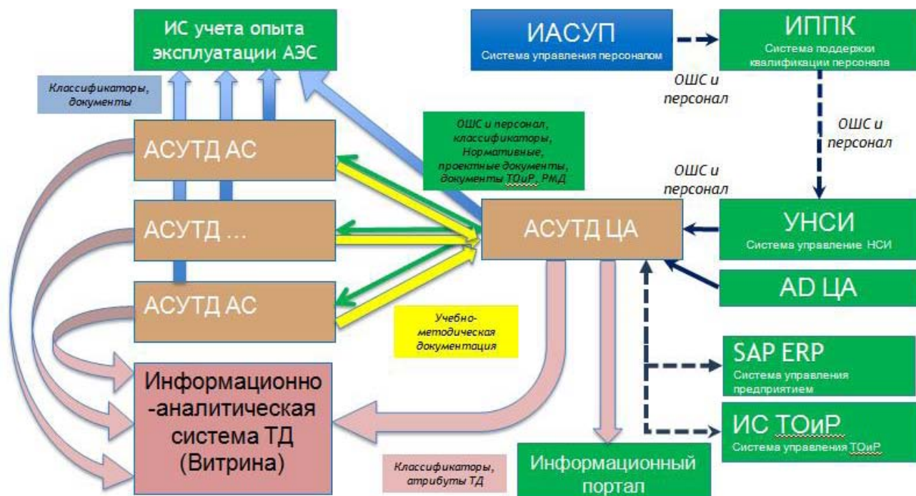
Рис. 4. Схема информационного обмена данными и документами системы АСУТД с другими информационными системами
