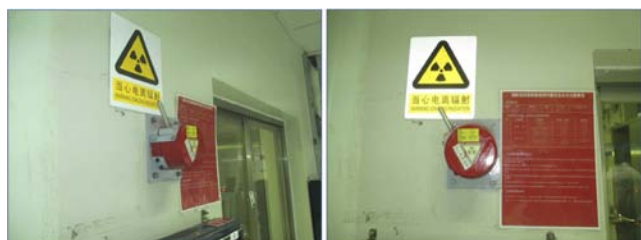
Пример размещения контрольного источника для оперативной проверки работоспособности переносных приборов РК (Китай)
