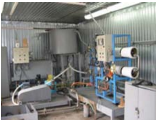
Рис. 3. Мобильная установка очистки жидких радиоактивных отходов
