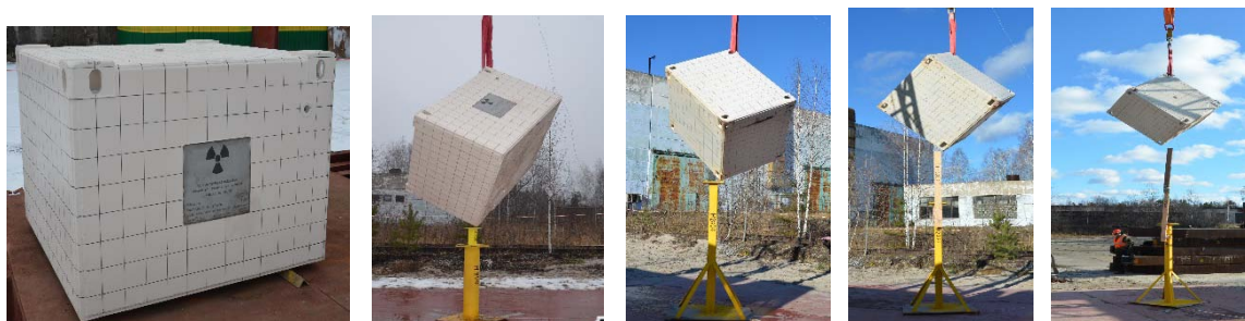
Рис. 2. Бросковые испытания НВК для размещения РАО 2 класса в ПГЗРО
