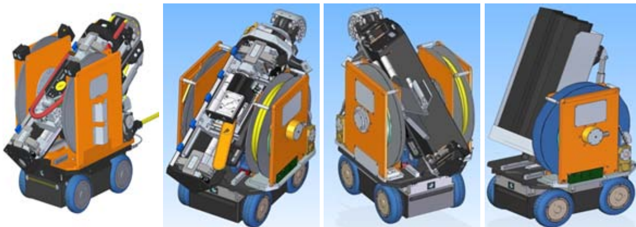
Рис. 5. 1 – Робот-доставщик с модулем резки фрезой; 2 – Робот-доставщик с модулем реза пилой; 3 – Робот-доставщик с модулем захвата; 4 – Робот-доставщик с контейнером накопителем
