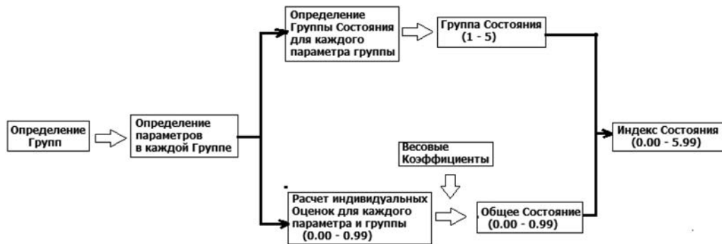
Рис. 9. Алгоритм расчета Индекса Состояния
