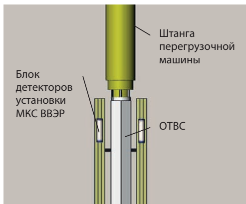
Рис. 7. Модернизированная схема измерений на специальной конструкции на стене БВ в режиме сканирования (второй вариант)
