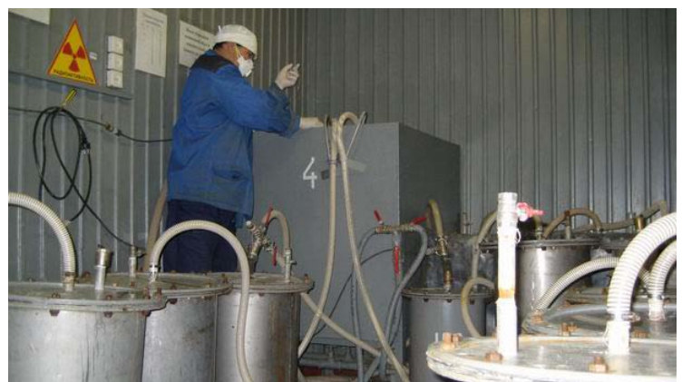
Рис. 3. Мобильная установка очистки жидких радиоактивных отходов
