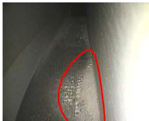
Рис. 4. Результаты бороскопии (следы разрядной активности)
