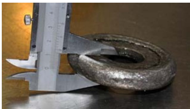
Рис. 6. Посторонние предметы, обнаруженные СОСП на АЭС Тянь-Вань (слева) и АЭС Бушер (справа)
