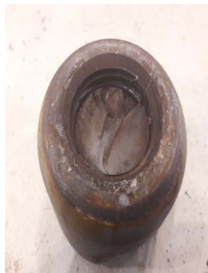
Рис. 5. Пружинный блок РКВД
