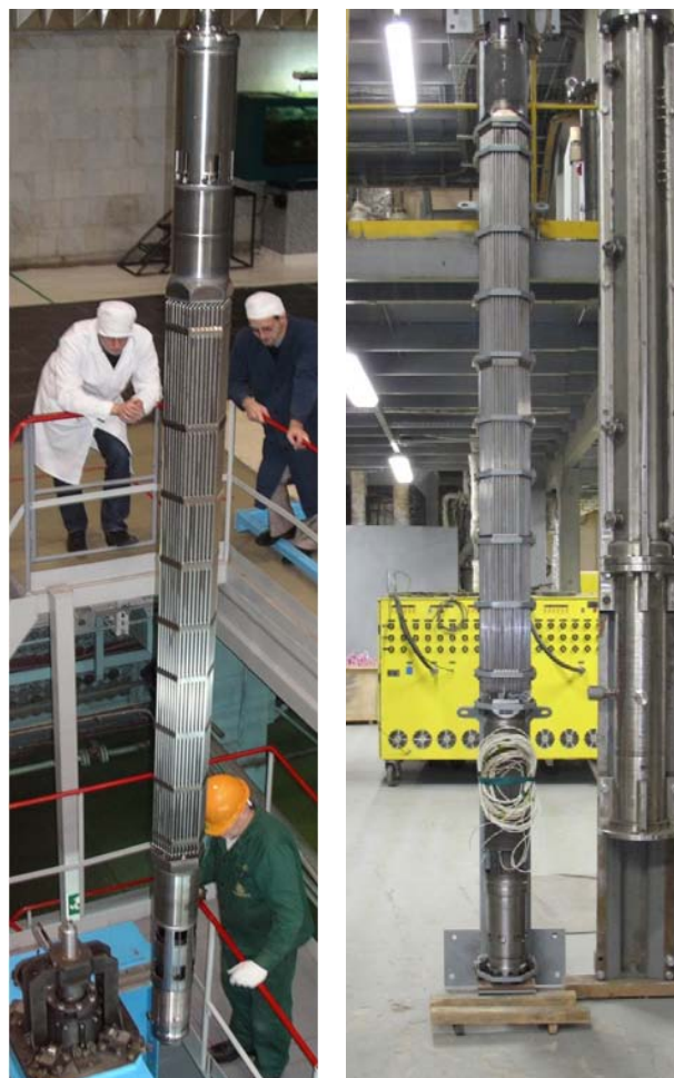
Рис. 1. Полномасштабный макет ТВС и макет ТВС с ретортой для испытаний
