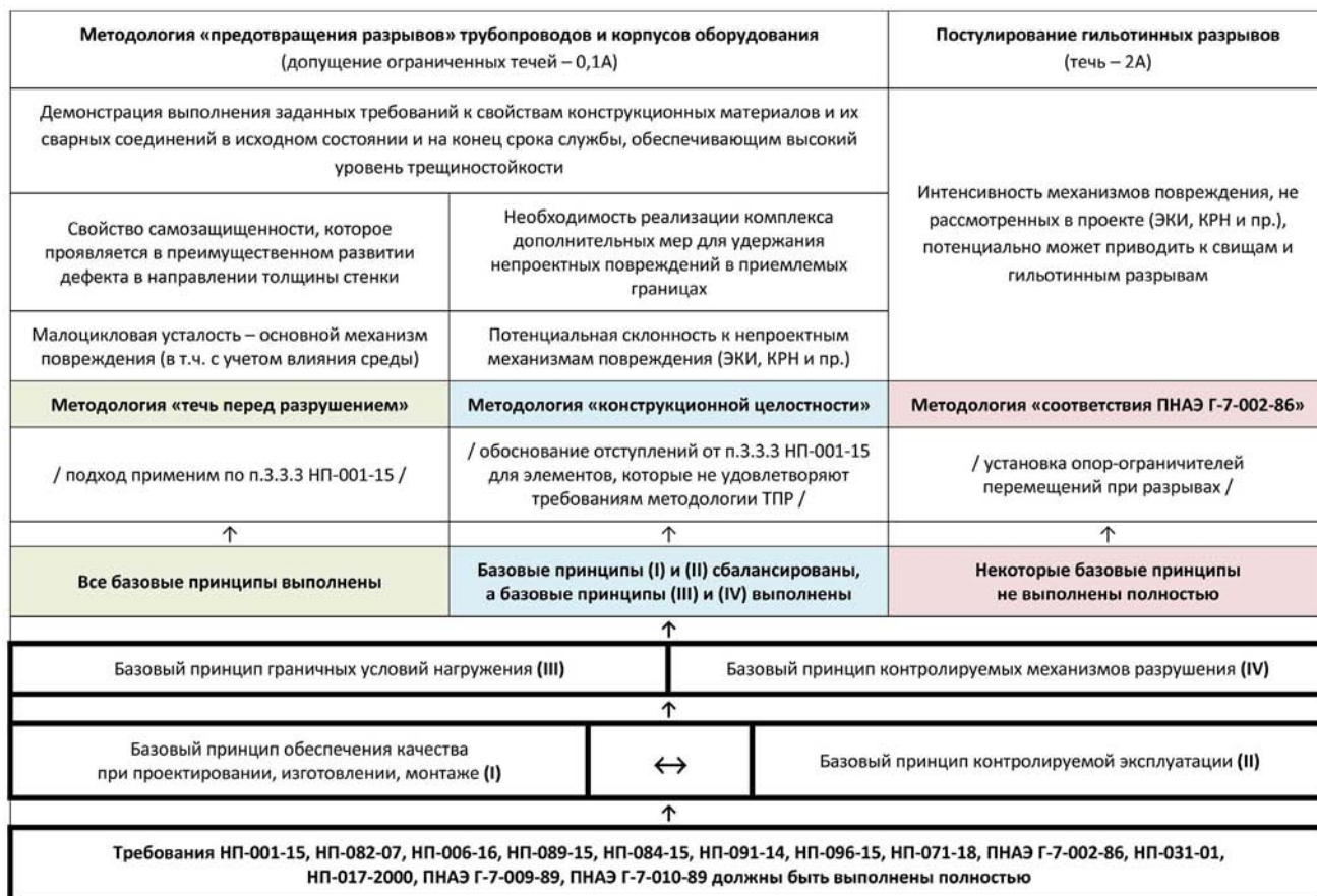
Рис. 1. Общая методология предотвращения разрывов трубопроводов (А - площадь проходного сечения трубы)
