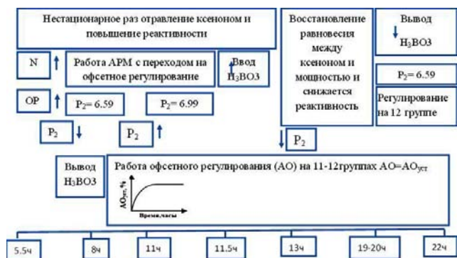
Рис. 12. Алгоритм управления реактором в дневном интервале времени для реализации суточного маневренного режима при минимизации водообмена
