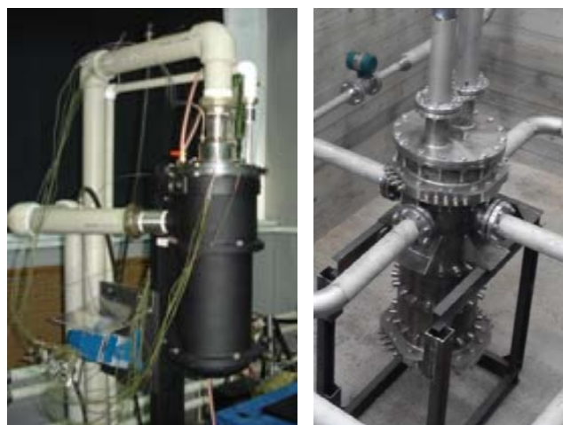
Модель напорной камеры реактора, установленная в АО «ОКБМ Африкантов»
