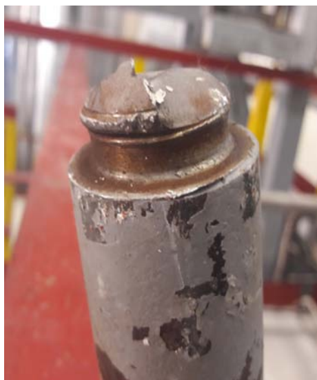
Рис. 6. Фото обрыва тяги пружинного блока РКВД № 4
