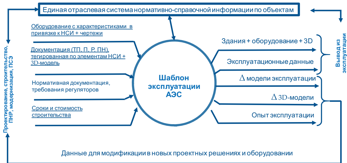
Рис. 3. Общая схема интеграции цифрового двойника
