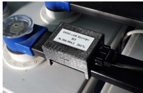
Рис. 5. Измеритель Тока (датчик Хола)
