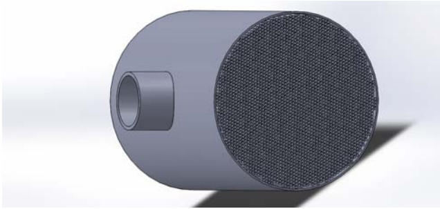
Рис. 9. Общий вид секции устройства для сепарации водорода, торец
