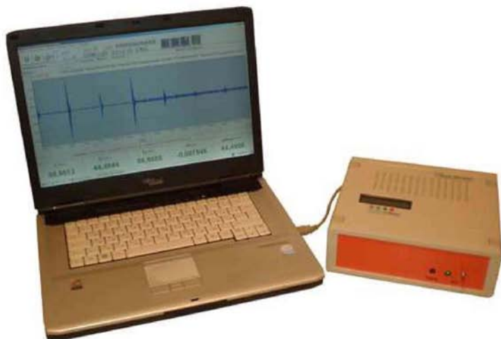
Рис. 1. Прибор для измерения механических напряжений ИН-5101А (исполнение 01)
