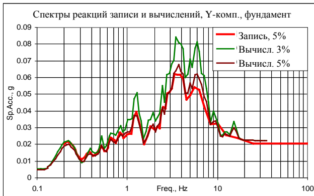
Рис. 7. Сопоставление спектров зарегистрированного и рассчитанного ускорений
