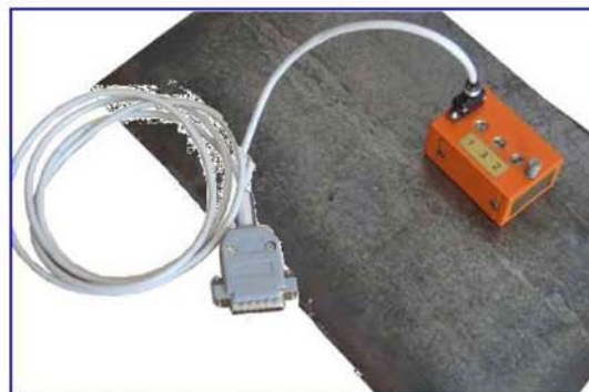
Рис. 1. Прибор для измерения механических напряжений ИН-5101А (исполнение 01)
