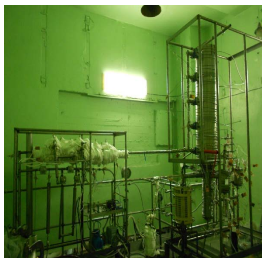
Рис. 12. Внереакторная петлевая установка со свинцовым теплоносителем и газовым контуром
