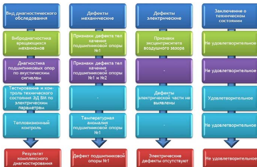
Рис. 2. Комплексная диагностика вращающихся механизмов АЭС, примененная на энергоблоке №3, 4 Ростовской АЭС
