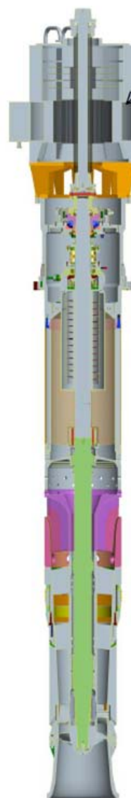
Рис. 11. Главный циркуляционный насосный аппарат РУ БРЕСТ
