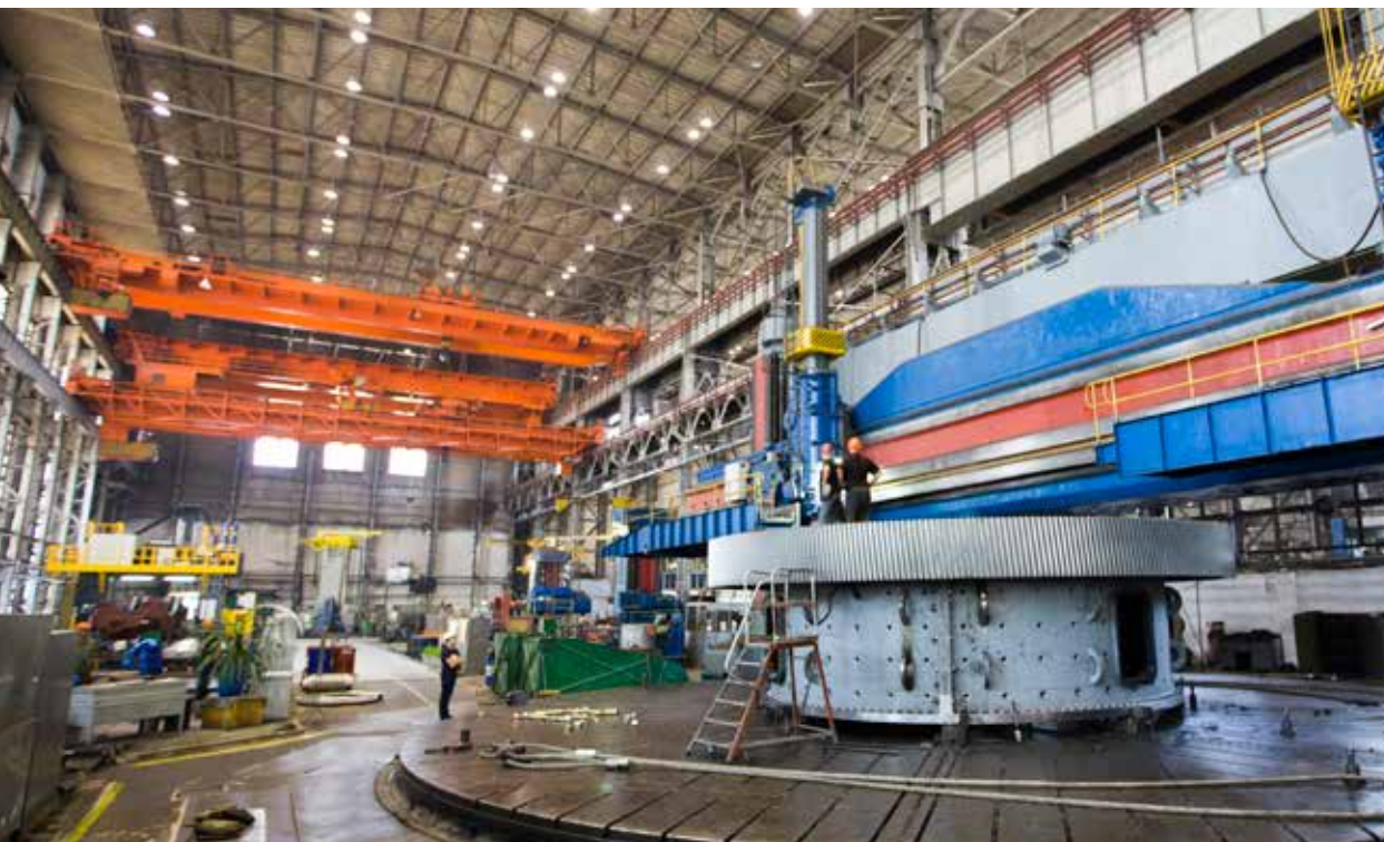
Механическая обработка корпуса барабана в сборе с зубчатым венцом мельницы ММПС для месторождения Рябиновое
