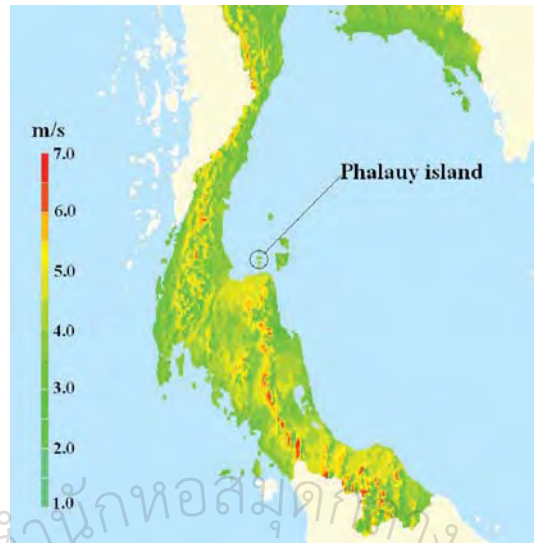
รูปที่ 3.74 การกระจายความเร็วลมบนเกาะพะลวยจากแผนที่ลมระดับสเกลปานกลาง
