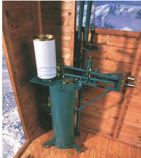
รูปที่ 2.17 แอนนิโมมิเตอร์แบบท่อความดัน
