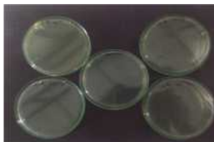
Gambar 2. Hasil Uji Perhitungan Angka Kuman Menggunakan Metoda TPC dari sample media nutrient broth yang dilakukan elektrosterilisasi 10 volt selama 10 menit.
