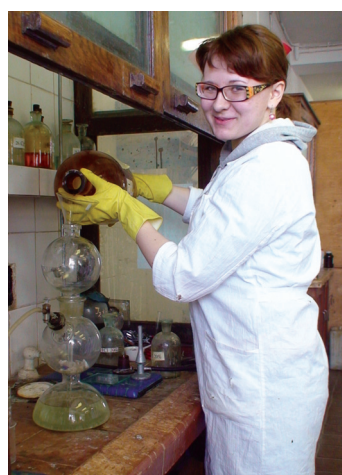
Рис. 1. Слева – наливаем кислоту в аппарат Киппа. Справа – заправленный аппарат Киппа крупным планом. В среднем шаре лежит мрамор
