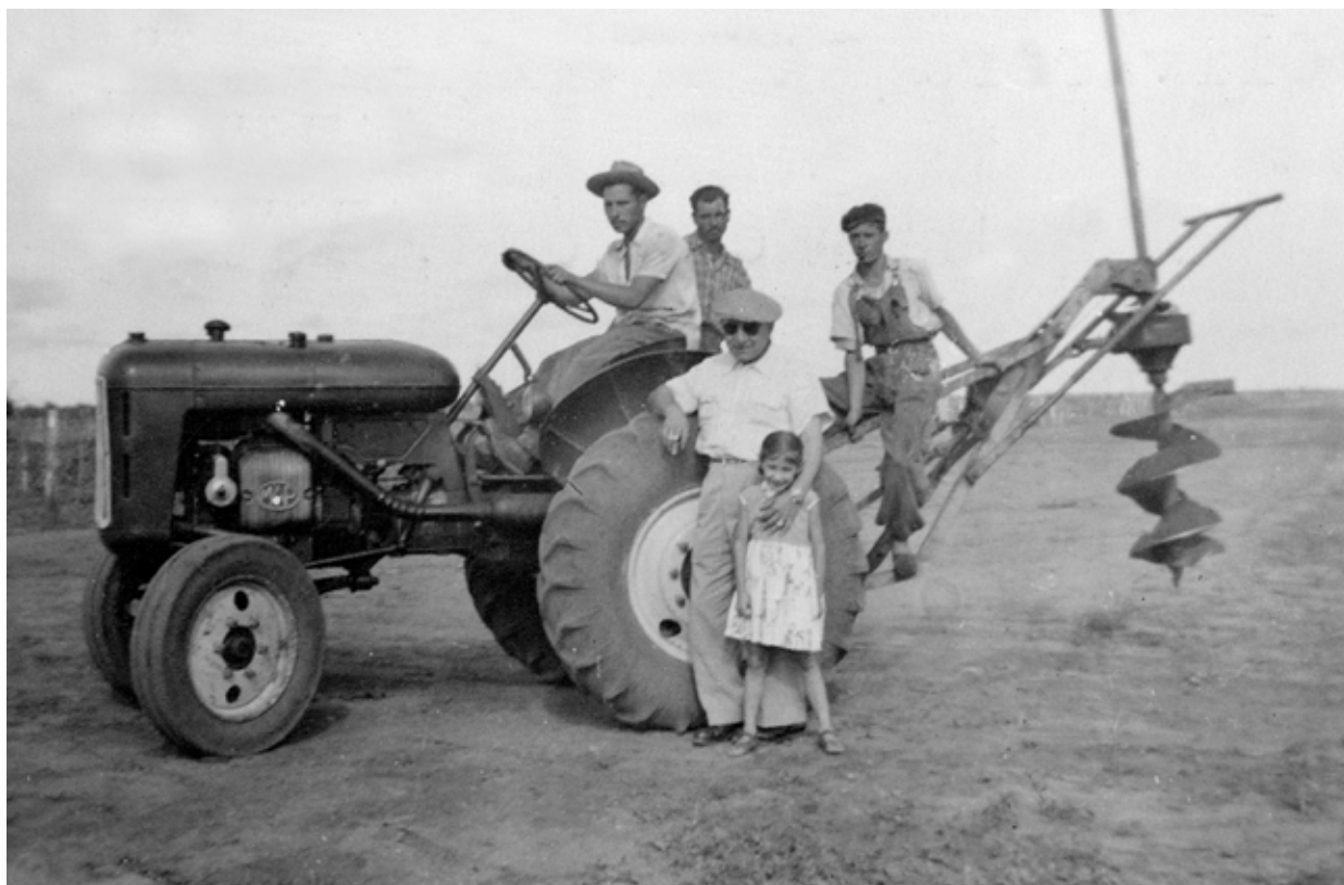
Máquina ahoyadora lista para entrar en acción, Chuña, Córdoba, 1955. Departamento Documentos Fotográficos. Inventario 224133.
