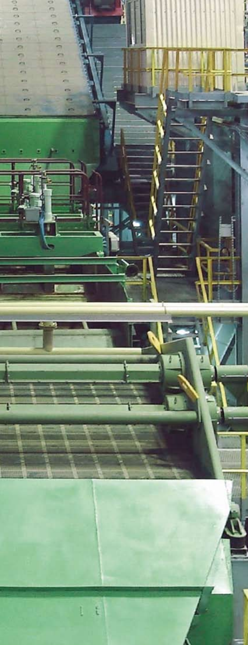
Отсадочная машина ВАТАС для обогащения угля с грохотами для обезвоживания и обесшламливания
