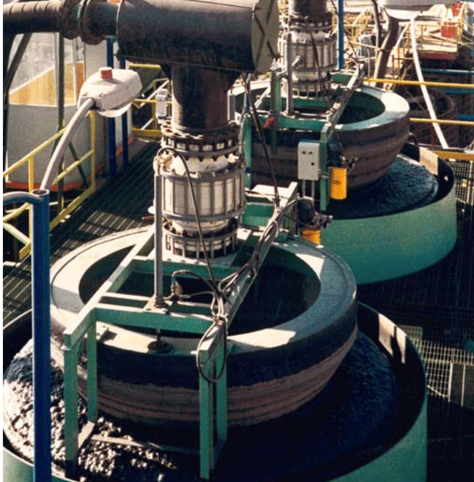
Флотационная камера PNEUFLOT, на медной руде в Чили
