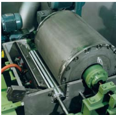
PERMOS для мокрой сепарации, пилотный, для проведения тестов
