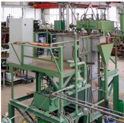
Отсадочная машина ВАТАС для угля Пилотный ВАТАС в нашем центре исследований и разработок / Кёльн
