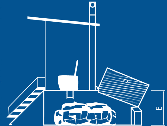
Fig.e: Visualización en corte acumulación de heces
