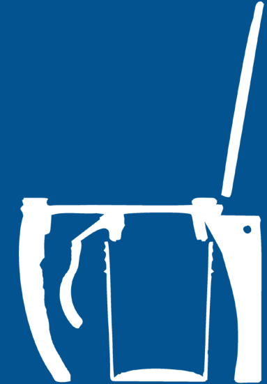
Fig.c: Vista en corte de inodoro seco con separación de orina INTI y contenedor interno
