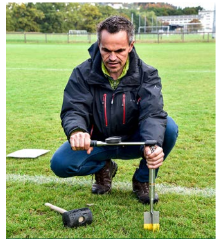
Felix Rusterholz misst die Scherkraft mithilfe eines Drehmomentenschlüssels.
