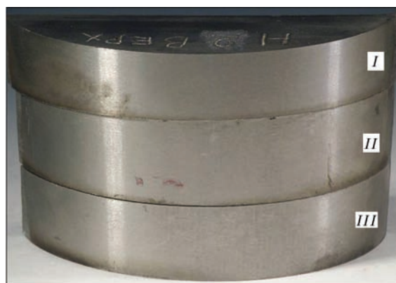
Рис. 2. Внешний вид поверхности заготовки-отливки диаметром 97 мм, полученной из возврата сплава ЖС26-ВИ способом ЭЛП: I — верхняя часть заготовки; II — средняя; III — нижняя
