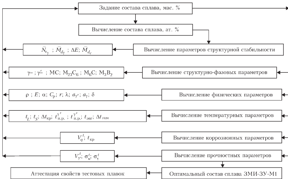
Рис. 1. Алгоритм компьютерного расчета проектируемого сплава ЗМИ-3У-М1 по разработанной методике КРАМ [12]
