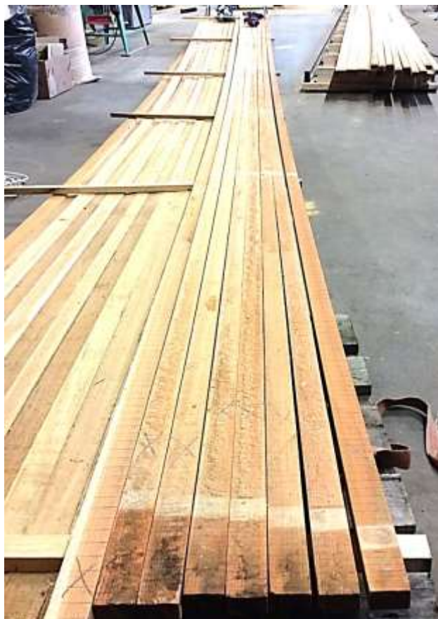
Bilden ovan visar läcker 1" x 1½-2" som användes i vingarnas längdriktning, på häcksked och skalk. Foto Mattias Hallgren, Forsvik
