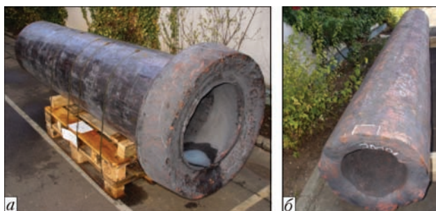
Рис. 5. Поковки для кристаллизаторов: а — изготавливаемых ковкой из слитка с прикованным фланцем (3,5 т); б — бесшовный кованый корпус (6,8 т)
