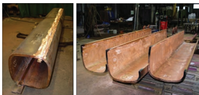
Рис. 2. Кристаллизаторы, изготавливаемые по обычной технологии прямоугольного сечения
