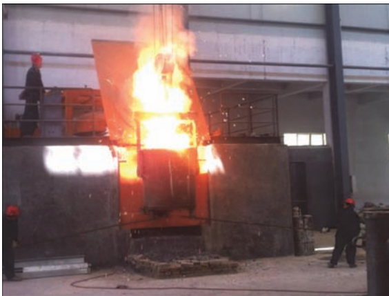
Рис. 4. Вакуумно-индукционная печь для дегазации металла в вакууме
