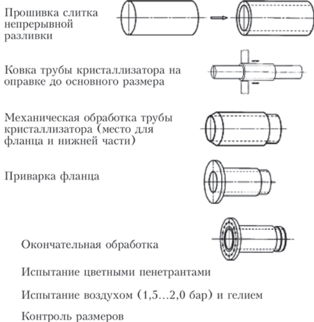
Рис. 6. Основные стадии производства круглых кристаллизаторов, изготавливаемых ковкой из слитков
