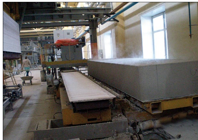
Рис. 2. Удаление нижнего подрезного слоя
