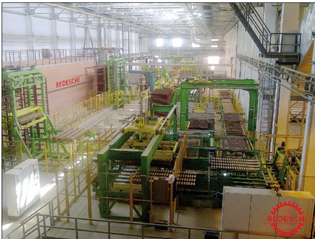
Автоматическая линия загрузки сырых изделий на сушильные тележки и выгрузки сухих изделий
