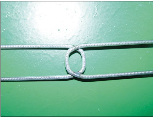
Рис. 1. Распорка для сборки и фиксации объемных армированных каркасов
