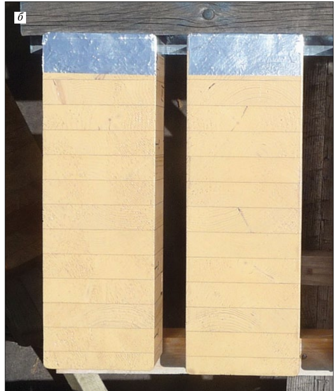
Рис. 5. Защита торцов несущих КДК каркаса навеса на санно-бобслейной трассе в г. Сочи комплексным покрытием, не скрывающим текстуру древесины (а), и образцы клееной древесины с этим покрытием после года экспонирования на открытом воздухе под углом 45^\circ к горизонту (б)
