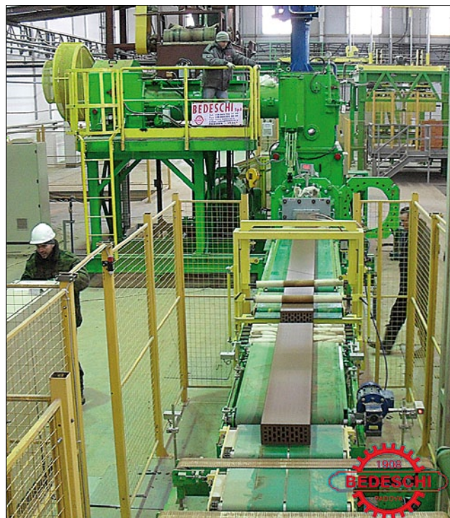
Экструдер модели BED 650 SLS с диаметром шнека 650 мм
