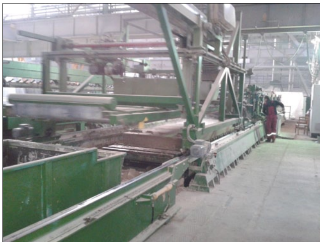
Рис. 7. Установка массива на стол резательной машины
