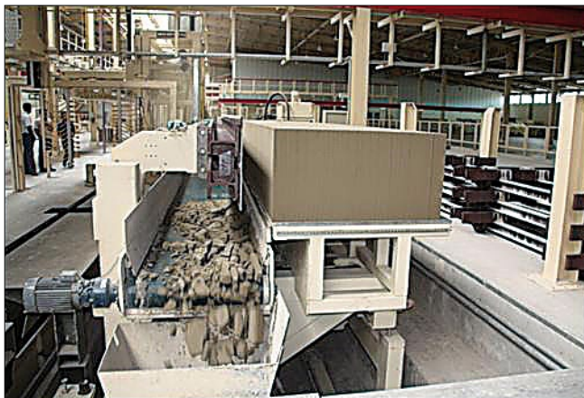
Рис. 1. Установка удаления нижнего подрезного слоя Wehrhahn позволяет экономить до 7% ресурсов
