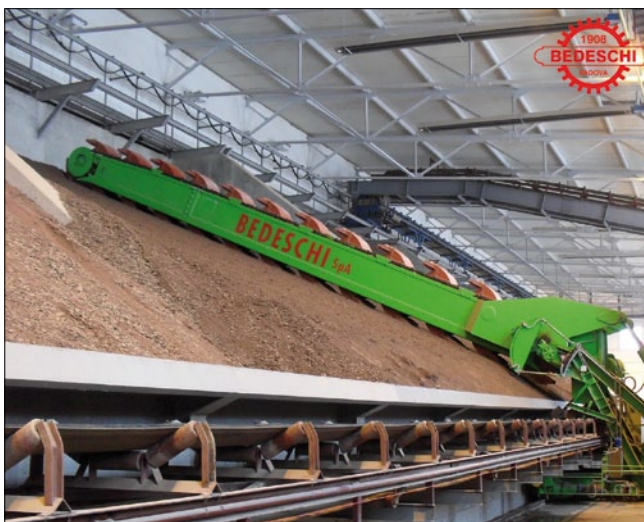
Боковой автоматический многоковшовый экскаватор BEL F
