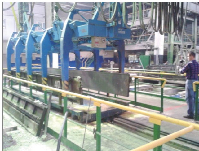
Рис. 8. Установка продольных бортов на поддон формы
