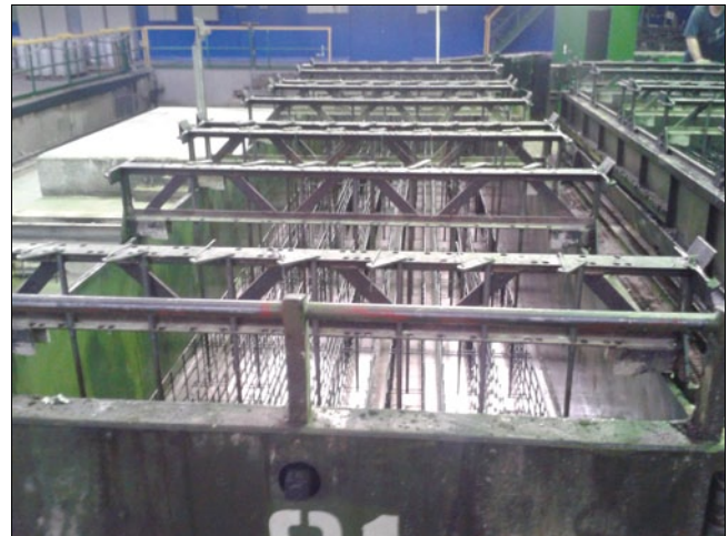
Рис. 4. Форма в сборе с установленным пакетом арматурных каркасов
