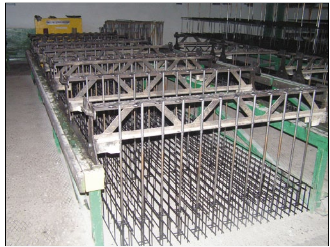
Рис. 2. Сборка пакетов армированных каркасов
