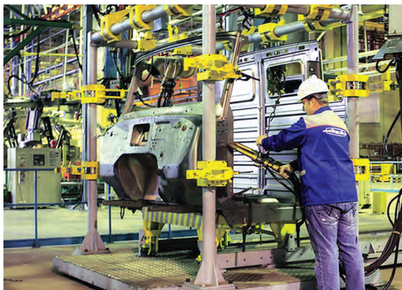
▲ Собранные в главном кондукторе детали кабины прихватываются подвесными сварочными машинами
