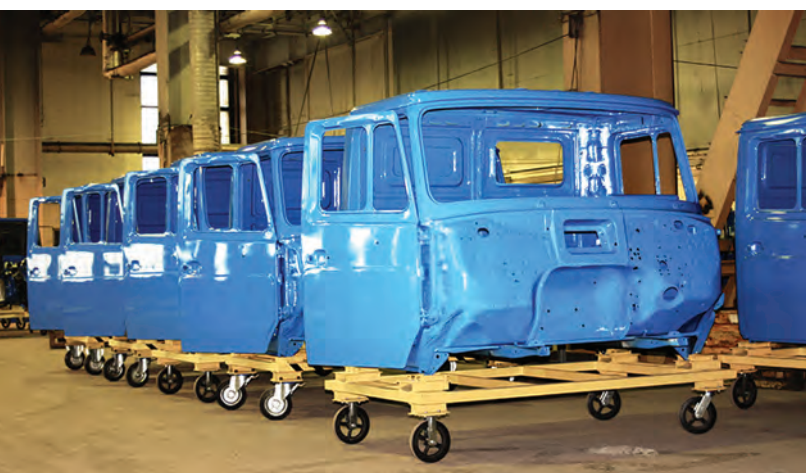
▲ Окрашенные кабины перед отправкой на участок сборки их интерьера
