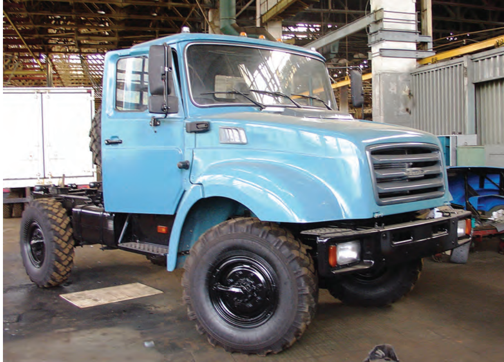
▲ Опытный образец двухосного полноприводного шасси ЗИЛ-43273Н со стеклопластиковыми капотом и крыльями
