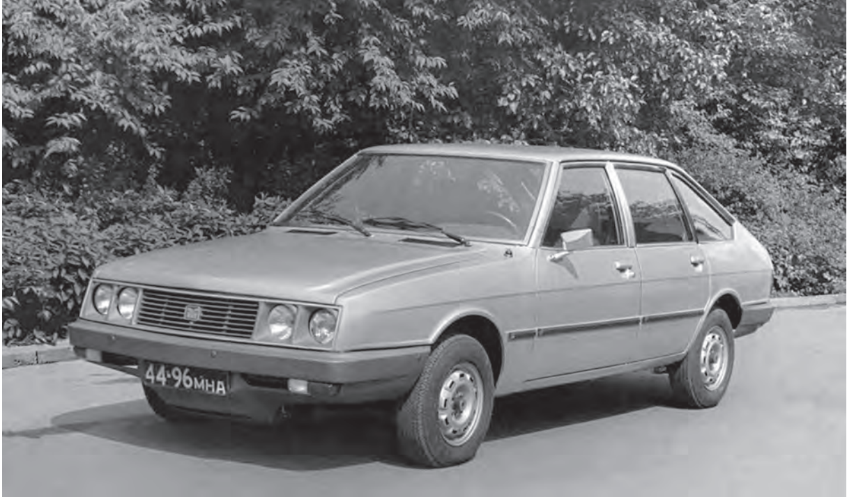
▲ Первый макетный образец АЗЛК-2141, созданный с использованием кузова и ходовой части автомобиля SIMCA-1308
