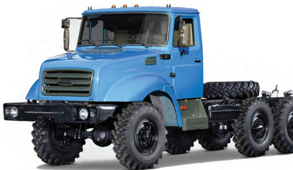
▲ Эскизная проработка установки стеклопластикового оперения на трехосный полноприводник ЗИЛ-4334
