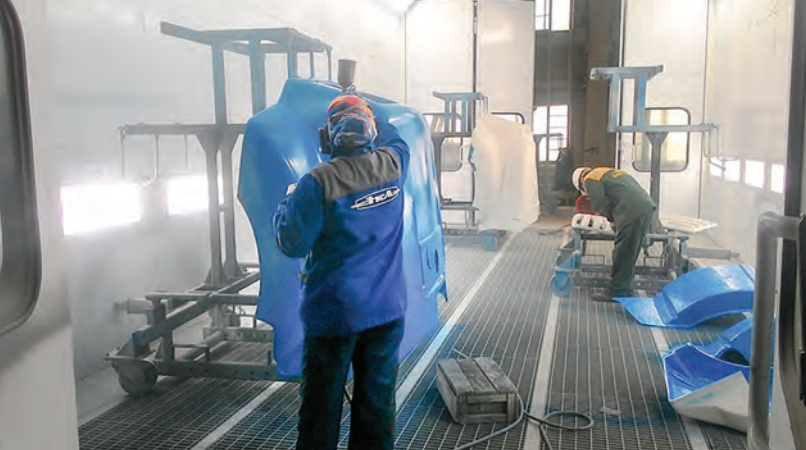
▲ В окрасочно-сушильных камерах с помощью пульверизаторов на оперение и кабину наносились грунт и эмаль
