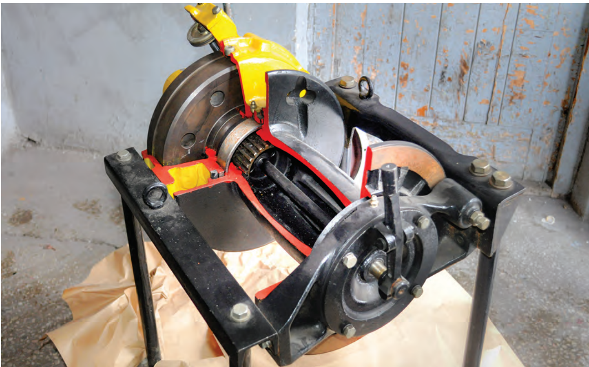
▲ Лебедка ЗИЛ-131 с гидроприводом. Справа показан рычаг муфты сцепления. В разрезе виден подшипник скольжения в левой опоре барабана; внутри расположены шток и муфта сцепления лебедки
