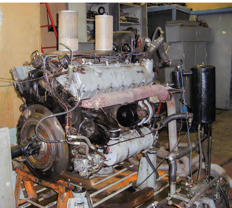
▲ Двигатель «Майбах» HL 230 на испытательном стенде в Экспериментальном цехе ЗИЛа
