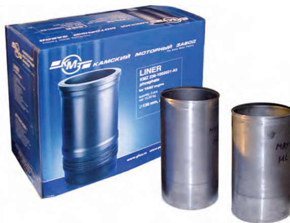
▲ «Родная» гильза двигателя «Майбах» HL 230 и ее копия, изготовленная из гильзы ЯМЗ-236
