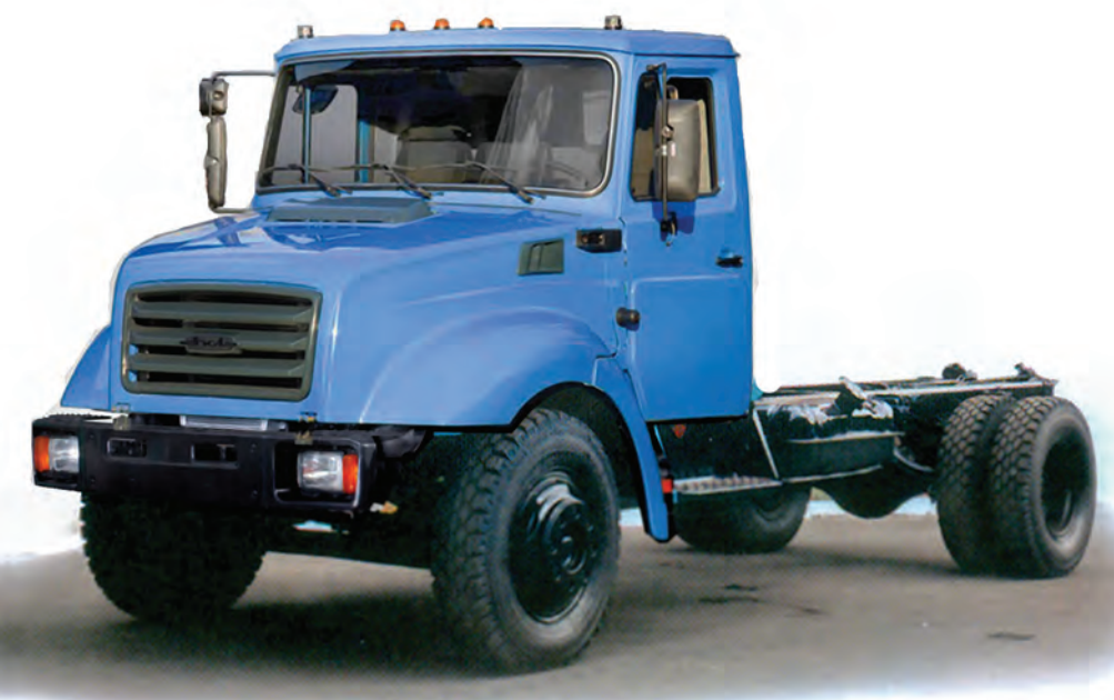
▲ Эскизная проработка установки нового стеклопластикового оперения вместе со стандартной кабиной на шасси ЗИЛ-432940, 4x2
