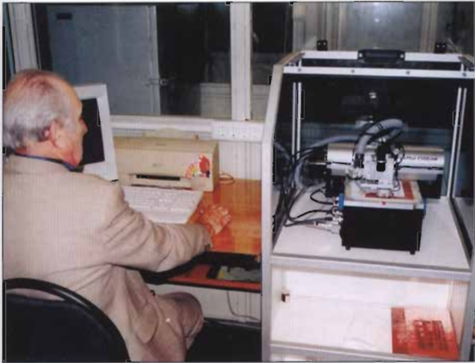
Рабочее место по изготовлению распределительных систем на микрополосковых линиях
