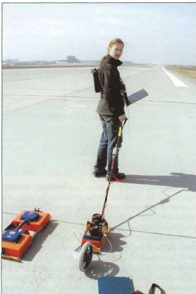
Исследование георадаром взлётной полосы
