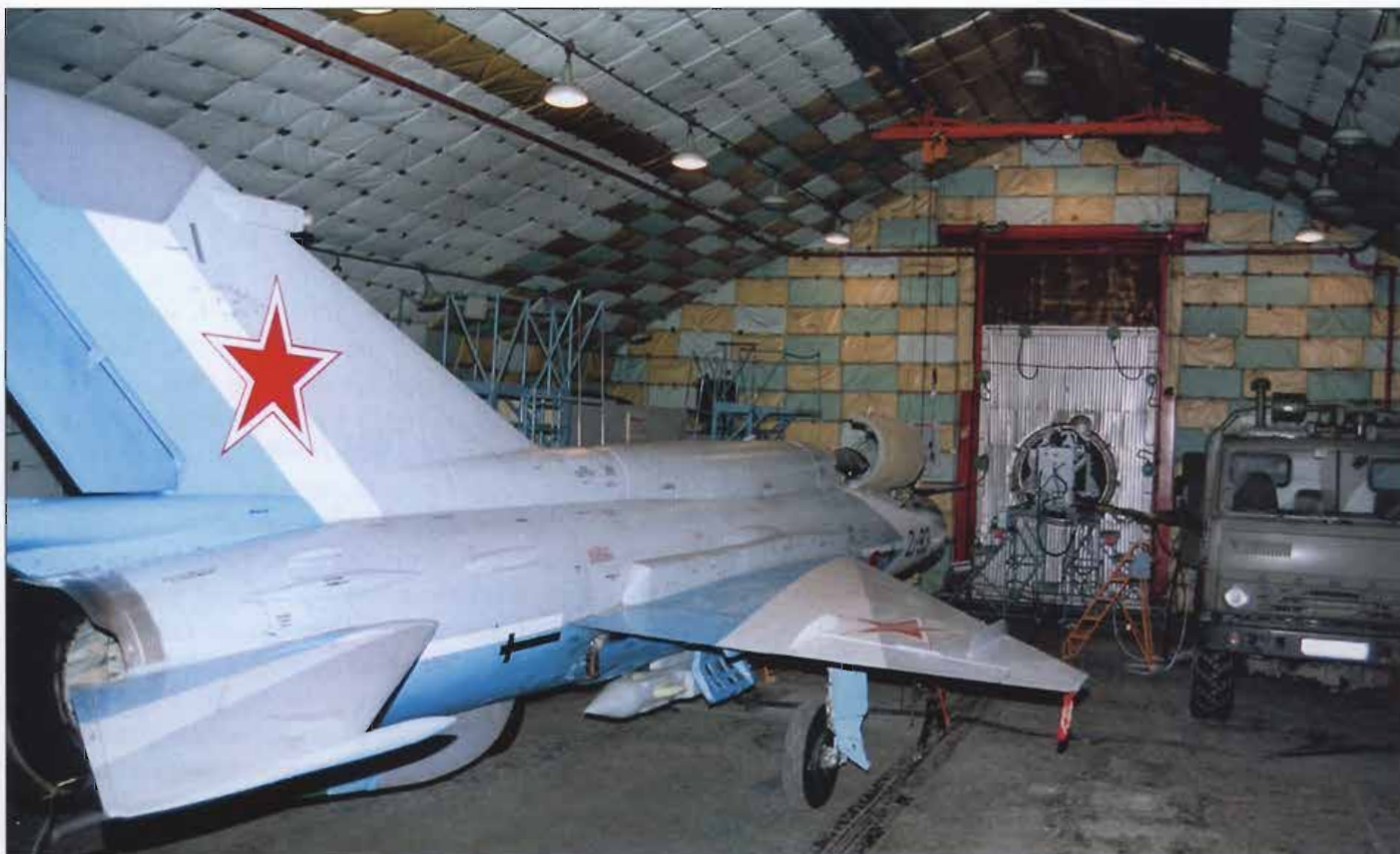
Наземные испытания РЛПК «Оса» на самолете МиГ-21-93
