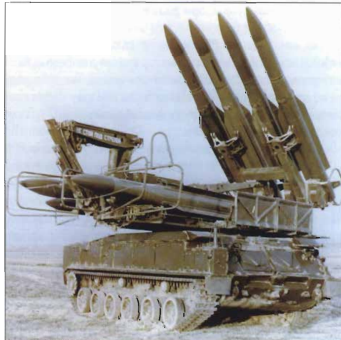
Пуско-заряжающая установка 9А39
