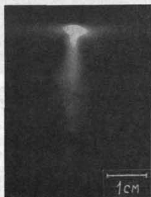
Рис. 7 Фотография пинча в свете мягкого рентгеновского излучения. Масштаб 1:1 ; (разрядная камера первого варианта). Горизонтальная полоса — свечение поверхности внутреннего электрода. Вертикальный столб — объемное свечение пинча.
