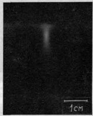
Рис. 10 Такая же фотография, как на рис. 7, но для разрядной камеры второго варианта с углублением в центре. Видно слабое свечения поверхности электрода у краев углубления. Основное свечение пинча оторвано от поверхности электрода.
