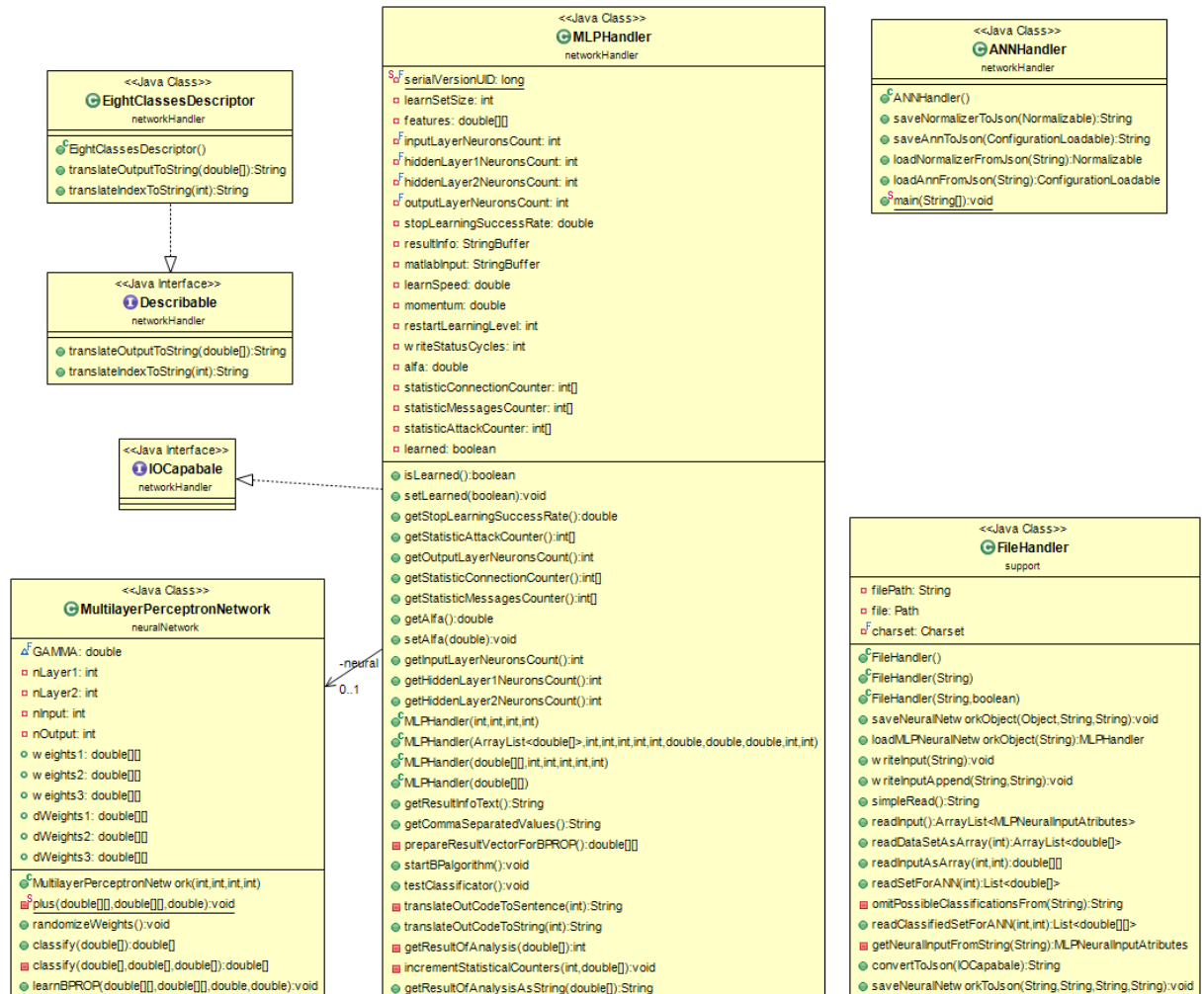
Obr. B.1: Třídní diagram pro MLP.
