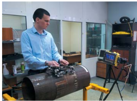
Специализированная многоканальная вихретоковая система контроля труб
