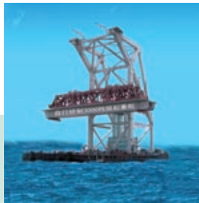
中铁大桥局自行研制的3000吨起重船
