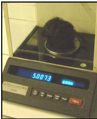
FIGURA 10. Fiocchi di lana pesati su bilancia tecnica: circa 5g di fibre pulite per ciascuna tesi (n. 8) a confronto.
