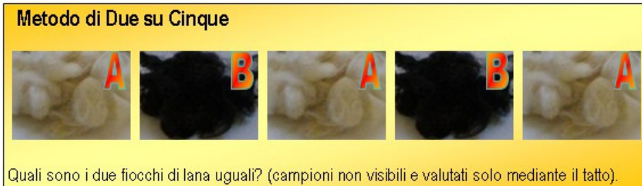
Figura 3. Esempio di metodo di due su cinque per campioni di fiocchi di lana.
