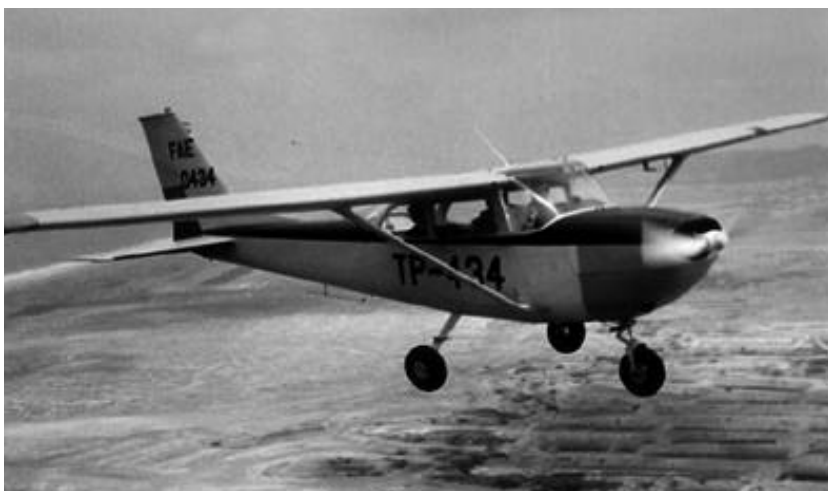
• Cessna T-41D Mescalero de la Escuela Superior Militar de Aviación Cosme Rennella en vuelo al SE de su estación. Esta avioneta de entrenamiento primario estaba equipada con un motor Avco Lycoming O-320-E2D de 150 HP y podía llevar cuatro personas con equipaje individual a 180 KPH. Salinas, 1971.
