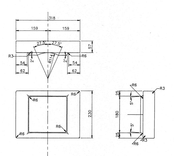
FOLLOWER MATERIAL: CAST STEEL AAR M201 GRADE E -OR ALTERNATIVELY CAST STEEL AS 2074 GRADE L6B2 -
