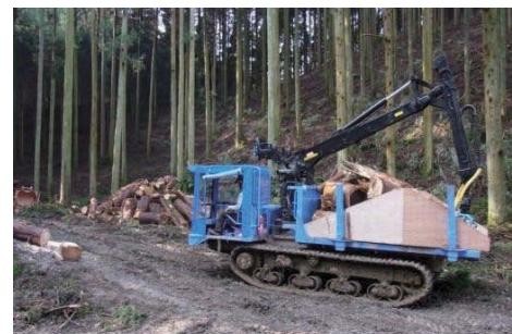
林地残材が落ちないように簡易枠を設置した集材車両
