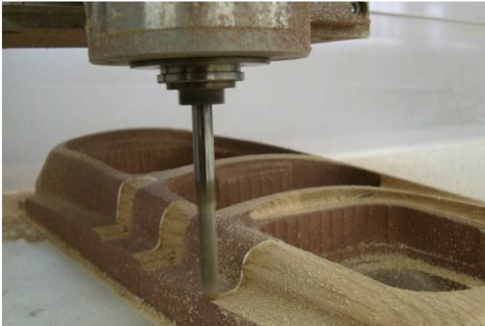
საკობრებელი დანადგარით მიმდინარეობს დეტალის დამუშავება.
