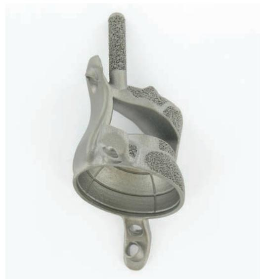
Bild 10. Für einen Patienten individuell additiv gefertigter Beckenteilersatz aus einer biokompatiblen Titanlegierung mit offenkarierte Struktur an der Knochen-Implantat-Schnittstelle (Quelle: implantcast)
