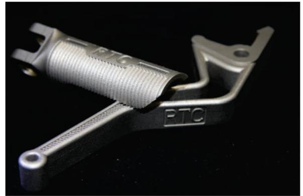
Bild 6. Bremshebel und Fußraste als laserstrahlgeschmolzene Ersatzteile (Quelle: RTC Universität Duisburg-Essen)
