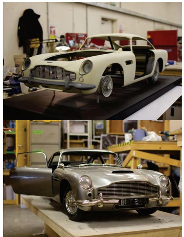
Bild 13. Additiv gefertigtes Karosseriemodell eines Aston Martin (oben) und fertig aufbereitetes Modell (unten) für eine Filmproduktion. (Quelle: Propshop Modelmakers)
