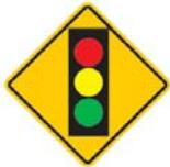
**การใช้** ป้ายเตือนสัญญาณไฟ ใช้เตือนล่วงหน้าก่อนถึงทางแยกในที่ซึ่งผู้ขับขี่ยวดยานไม่คาดว่าจะมีไฟสัญญาณหรือในกรณีที่มองเห็นไฟสัญญาณได้ไม่ชัด เนื่องจากโคลงรับ โคลงตั้ง มีแสงสว่างรบกวน หรือบริเวณชานเมืองหรือนอกเมืองที่มีไฟสัญญาณควบคุมการจราจร โดยที่ผู้ขับขี่ยวดยานไม่สามารถมองเห็นไฟสัญญาณได้ในระยะ 200 ม. ก่อนถึงทางแยก
