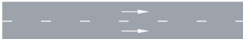
เส้นแบ่งช่องเดินรถปกติ เป็นเส้นแบ่งช่องเดินรถหรือ ทางจราจรที่มีทิศทางเดียวกัน ความหมายให้ขับรถภายในช่องจราจร หรือช่องเดินรถ ห้ามขับคร่อมเส้น เว้นแต่จะเปลี่ยนช่องจราจรหรือช่องเดินรถ **การใช้** ให้ใช้เส้นแบ่งช่องจราจรปกติบนทางหลวงที่มีการจราจรแล่นไปในทิศทางเดียวกันตั้งแต่ 2 ช่องจราจรขึ้นไป ในบริเวณที่ยอมให้รถเปลี่ยนช่องจราจรได้
