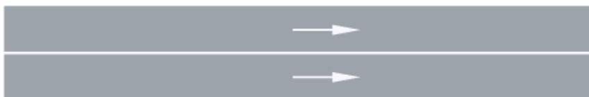
เป็นเส้นแบ่งทางเดินรถ หรือทางจราจรในทิศทางเดียวกัน ให้เป็นช่องทางเดินรถ หรือช่องจราจร ความหมาย ให้ขับรถภายในช่องจราจร หรือช่องเดินรถ ห้ามขับผ่าน หรือคร่อมเส้น
