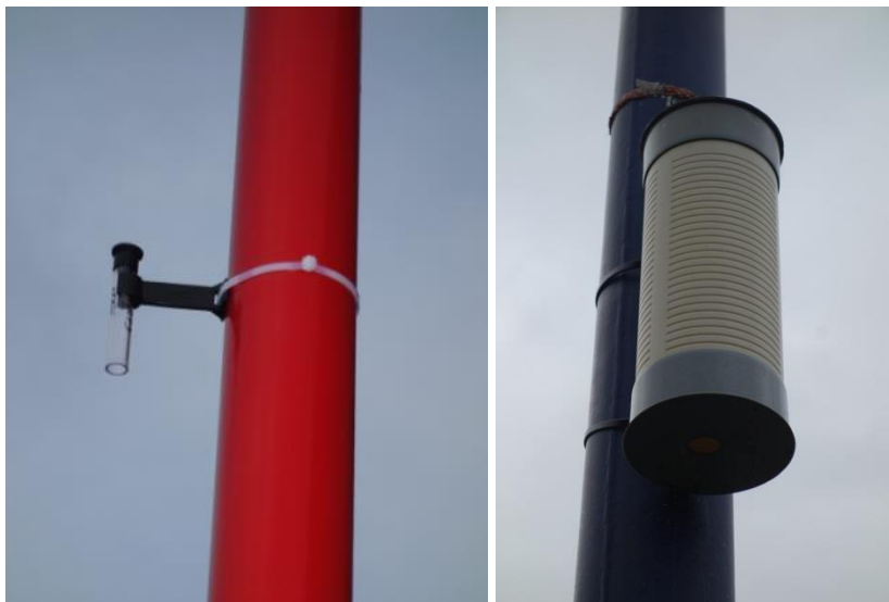
Palmes buisje bevestigd aan lantaarnpaal in houder (links) en in meetkoker (rechts).
