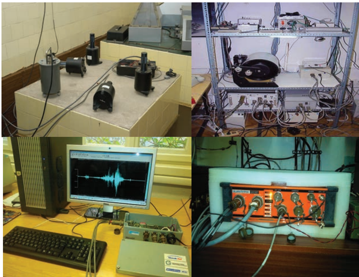
Модерни инструменти во Сеизмолошката опсерваторија при ПМФ во Скопје: (горе лево) краткопериодични и фреквентно широкопојасни електромагнетски сеизмометри; (горе десно) дигитален запишувач SSR-1; (долу лево) дигитален запишувач WAVE24 заедно со добиената дигитална регистрација на компјутерски монитор; (долу десно) дигитален запишувач Quanter-Q330HRS.
