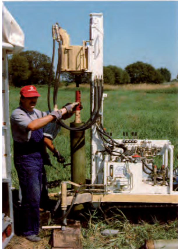
Abb. 20 Untersuchung von Baugrundeigenschaften an der ICE-Trasse Hannover-Berlin
