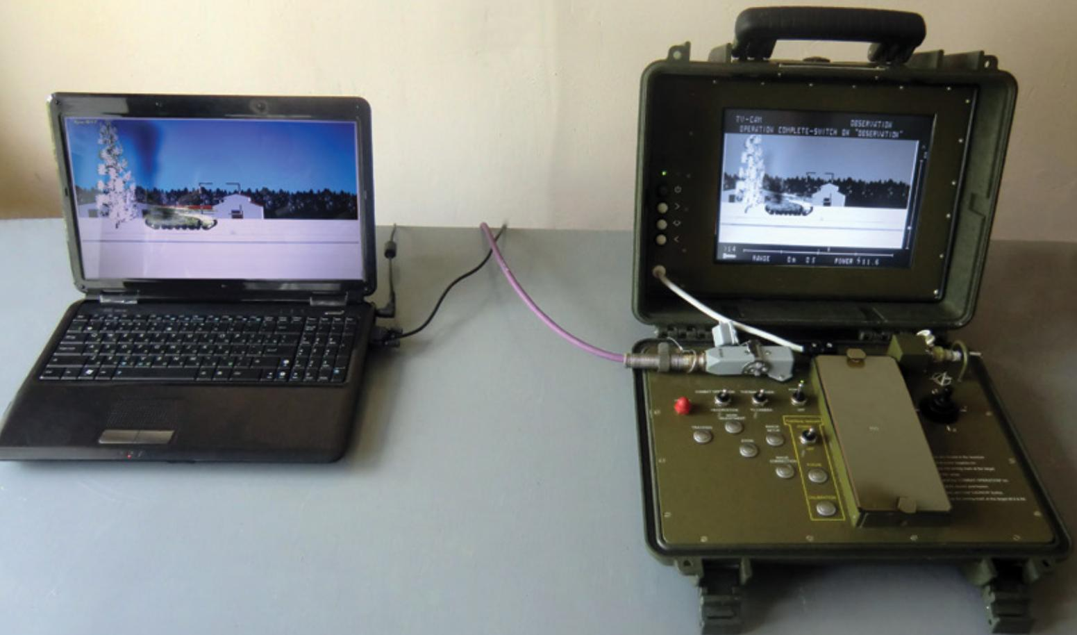
**Тренажер СКИФ-УТС1.10** предназначен для обучения, формирования и совершенствования практических навыков работы с переносным противотанковым ракетным комплексом «СКИФ» в условиях учебного класса.
