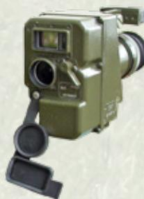
Процессорное устройство гранатомета осуществляет автоматический ввод баллистических поправок и корректировку положения прицельной марки, что обеспечивает точность при максимальной дальности стрельбы.
