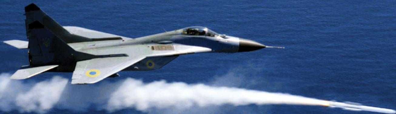
**Высокоманевренная авиационная управляемая ракета класса «воздух-воздух» ближнего воздушного боя** с инфракрасной головкой самонаведения, неконтактным радиолокационным датчиком цели в миллиметровом диапазоне и управляемым вектором тяги двигателя предназначена для перехвата и поражения высокоманевренных средств воздушного нападения и разведки при атаке:
