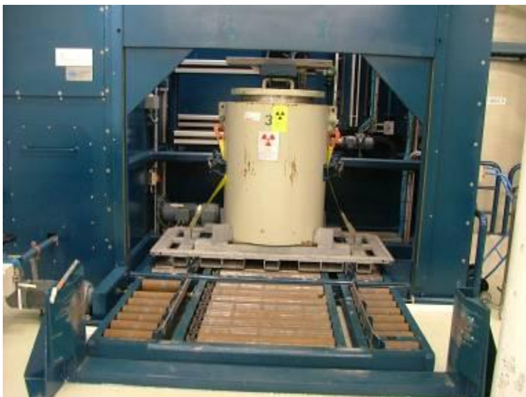
Figuur 6.8: Invoersluis van de vloeistofleeginstallatie met daarin een transportcontainer voor molybdeenproductie afval
