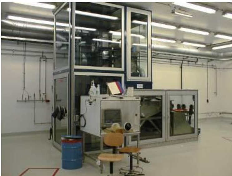
Figuur 6.9: Maalininstallatie voor de verwerking van telpotjes
