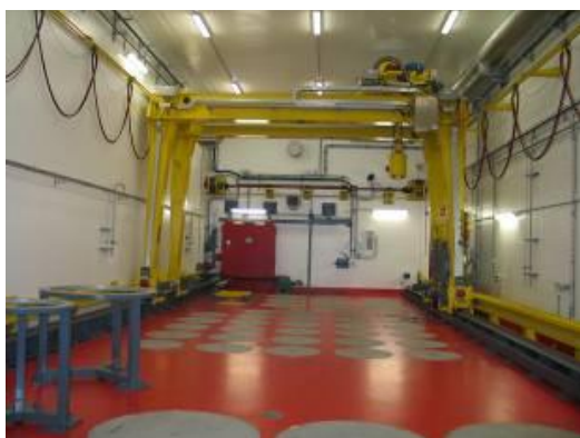
Figuur 8.8: Beladingsruimte boven de opslagcompartimenten voor warmte-producerend HRA
