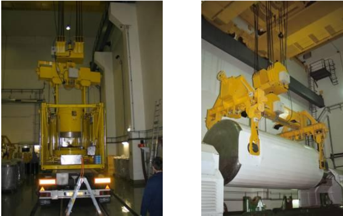
Figuur 8.2: Voorbeelden van aangeleverde containers: links MTR-2 met HRA splijtstofelementen en rechts TN28 met verglaasd HRA
