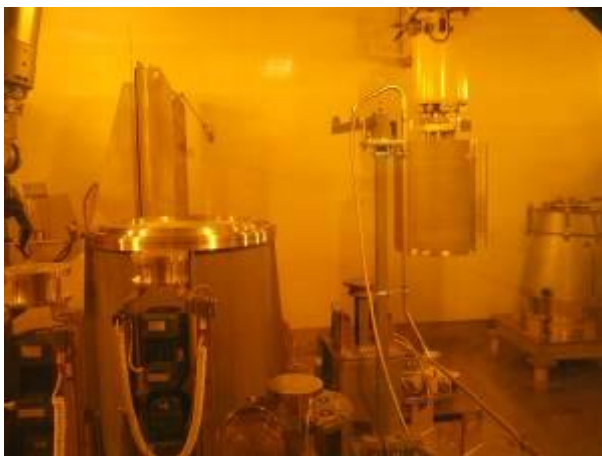
Figuur 8.4: Overbrengen van een korf met splijtstofelementen
