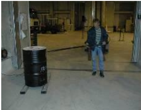
Figuur 7.2: Meting van het dosistempo van geconditioneerd afval
