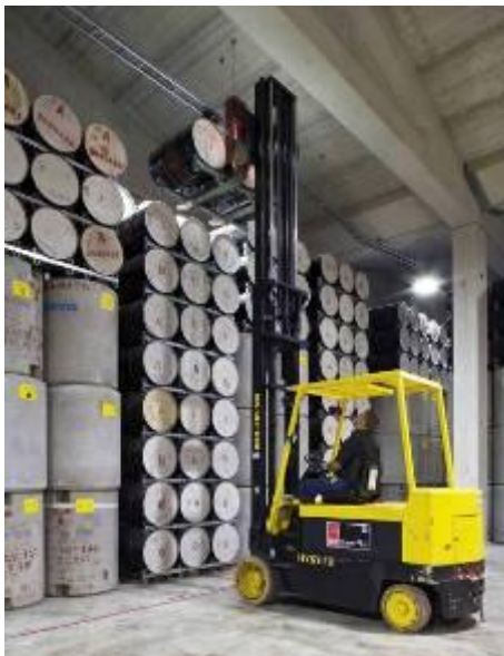
Figuur 7.3: Stapelen van geconditioneerd afval in 200-litervaten
