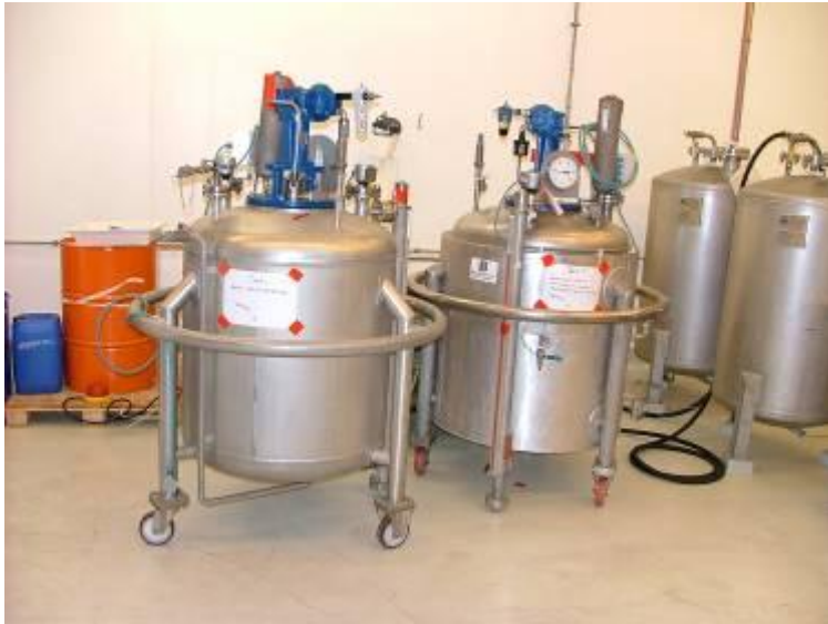
Figuur 6.6: Mobiele tanks en vast opgestelde tanks met een inhoud van 600 liter
