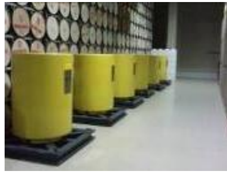
Figuur 7.4 a) Tijdelijke opslag van containers met U_3O_8 containers b) Opslag van radioactief afval in type B containers
