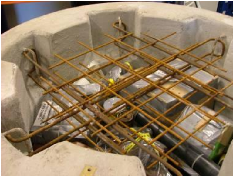
Figuur 6.11: Bronnen overgepakt in een 1000 l betoncontainer
