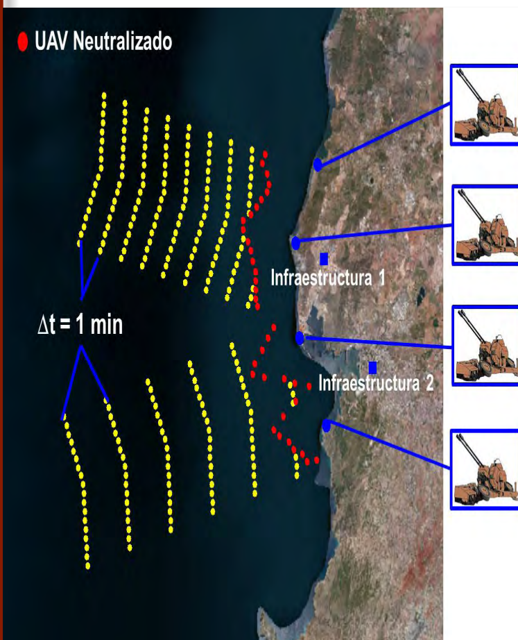
Ilustración 11. Ejemplo de la evolución dinámica de los swarms y la neutralización de los UAVs por los efectores del GBAD (Opción A: 4 piezas de 35 mm y munición AHEAD)
