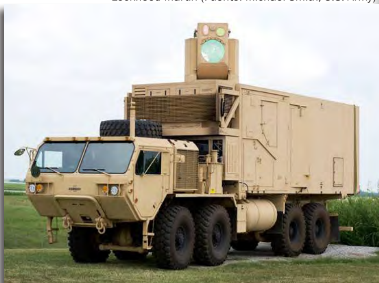
Ilustración 6. Demostrador móvil del láser de alta energía de Boeing (Fuente: U.S. Army)
