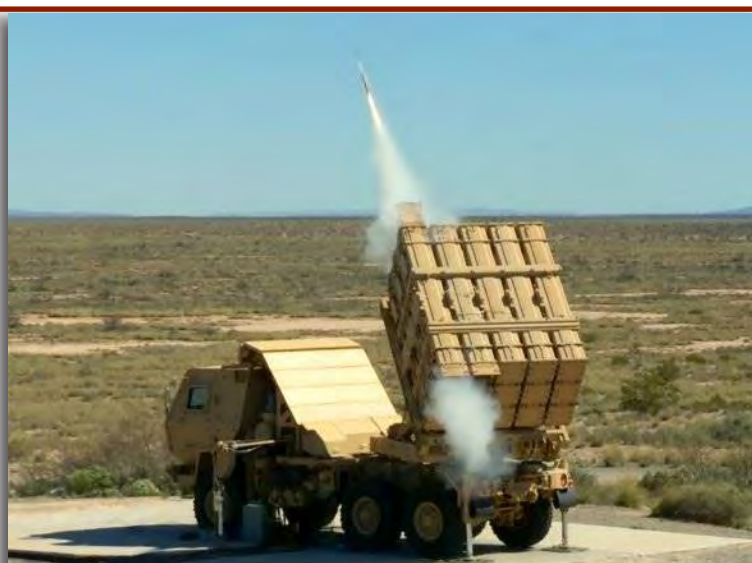
Ilustración 5. Lanzador multi-misión disparando el mini-misil MHTK de Lockheed Martin (Fuente: Michael Smith, U.S. Army)
