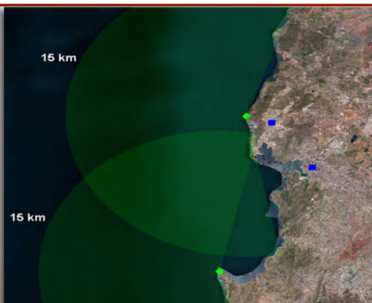
Ilustración 9. Despliegue de 2 radares GBAD con mejoras para la detección de amenazas LSS
