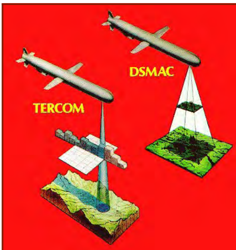
Sistemas TERCOM y DSMAC. Fuente: technologyreview.com (internet)
