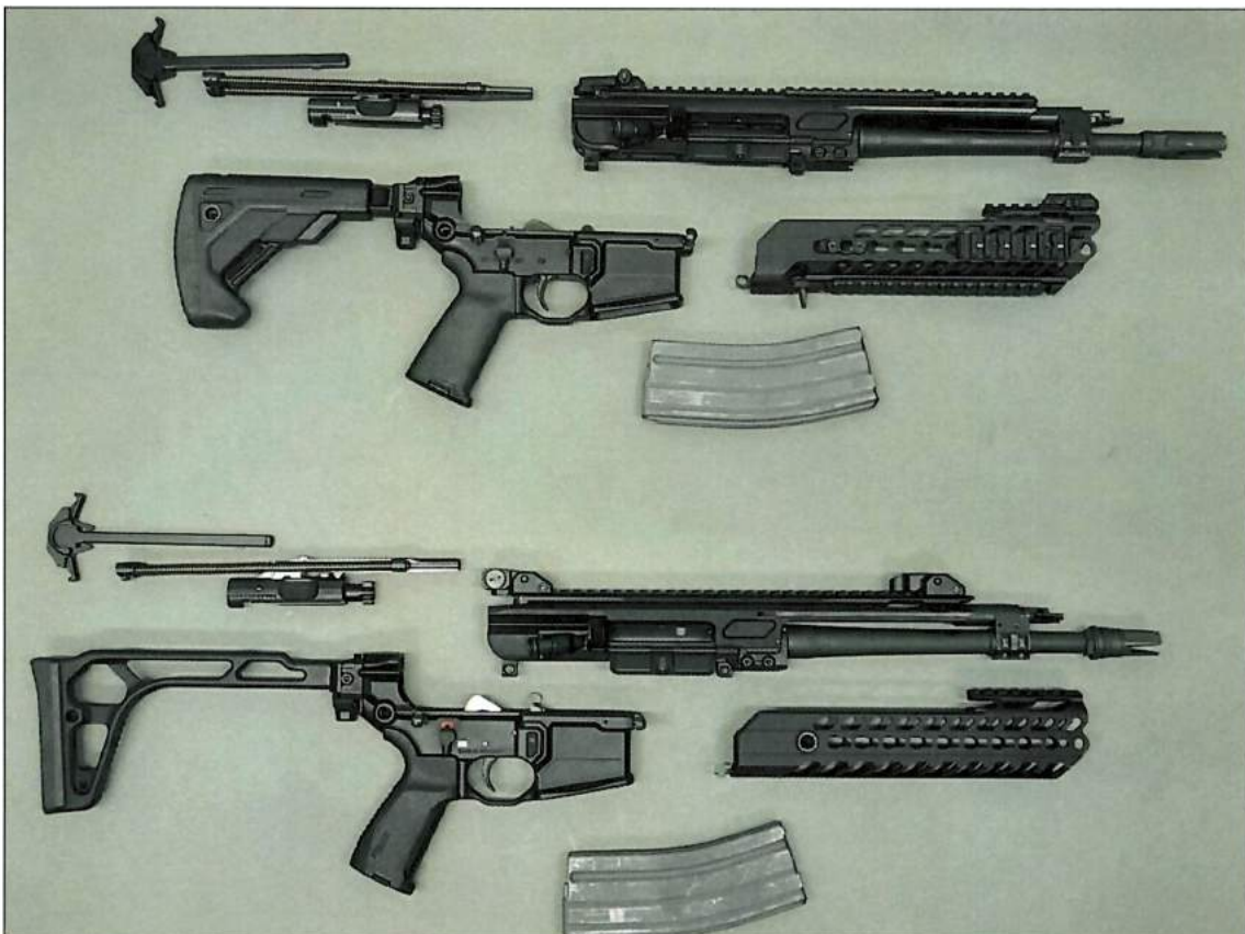
Abbildung 4: Vergleichsansicht linke Seite, oben die vollautomatische „SIG MCX“, unten die halbautomatische „SIG MCX Sport“, beide zerlegt in die jeweiligen Hauptgruppen
