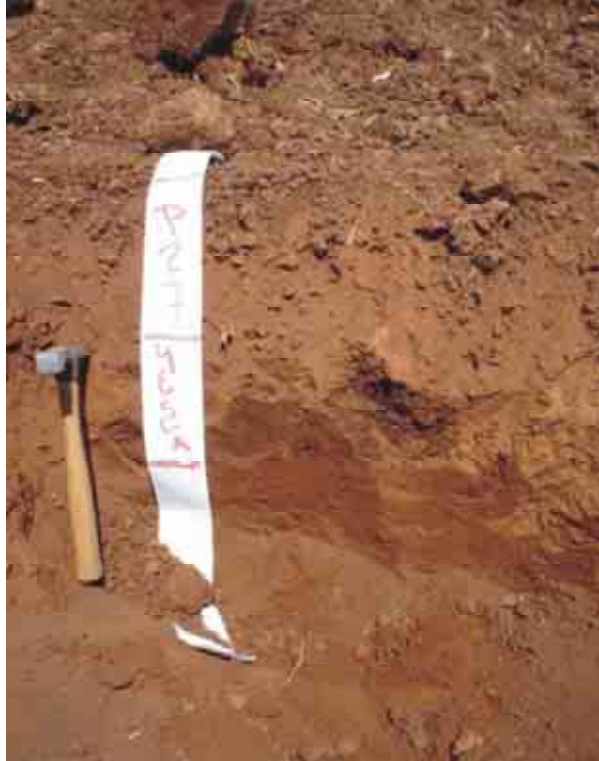
Figura 39 Perfil del Suelo (P – 27), de color rojizo y la estructura blocosa, debido al contenido de arcillas.
