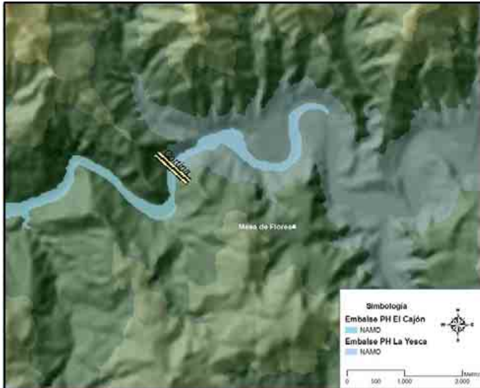
Figura 55. Nivel máximo del PH El Cajón y zona proyectada para la cortina del PH La Yesca.
