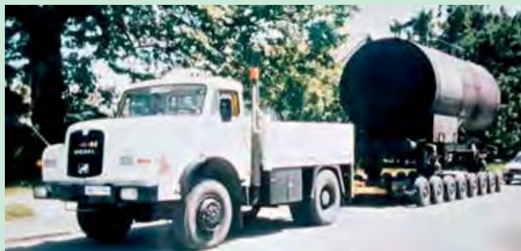
Ein Tankwaggon, beladen mit Naturlatex wird auf dem Straßenroller mit MAN-Zugfahrzeug ins Werk gezogen zur Entladung
