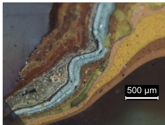
20. Wismari 27 hoone akna piirdeliistu viimistluskihtide mikrolihv mikroskoobi all pildistatuna.
