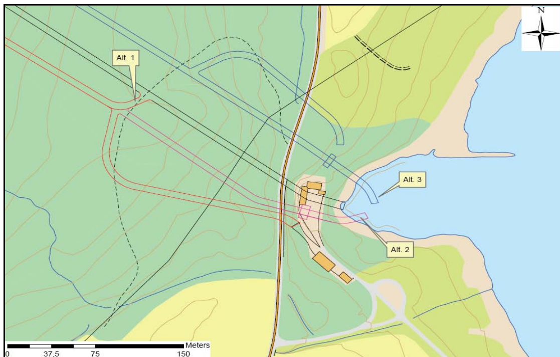
Figur 4.5 Alternative arrangement for inntak ved Grendstad.
