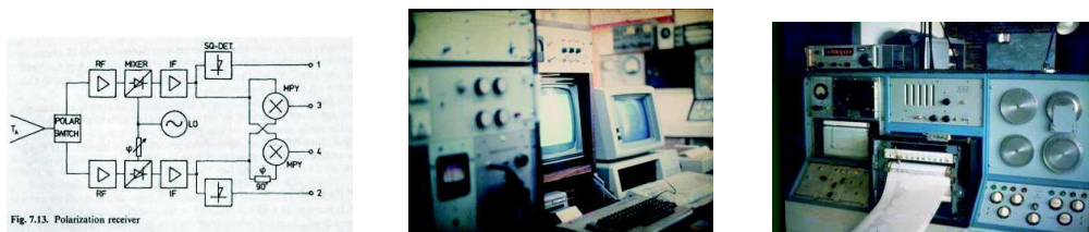
Figura 42 Izquierda: Esquema de un polarímetro (Rohlf 1990). Centro: Receptor y computadoras utilizadas para el relevamiento en el continuo en 21 cm. Derecha: Parte de la consola con los controles para la Antena 2.
