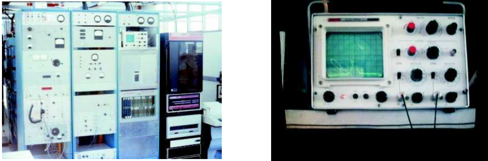
Figura 32 Izquierda: Bastidores para: control del FE, FI y multiplexer. PDP11, unidad de cinta magnética e impresora. Derecha: Perfil en el osciloscopio.
