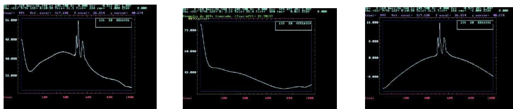
Figura 46 1: Perfil ON. 2: Perfil OFF. 3: Perfil ON-OFF.
