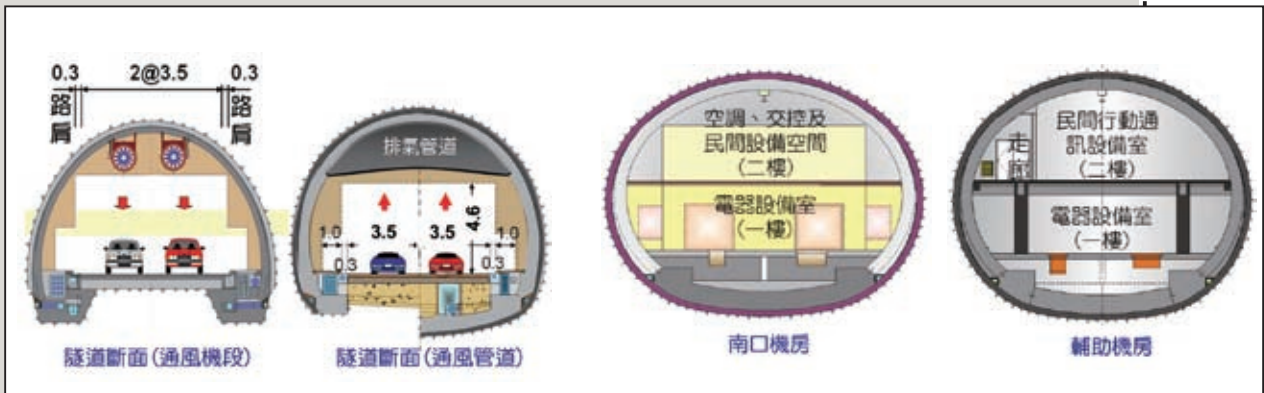
圖8 主隧道、機房及輔助機房標準斷面圖
