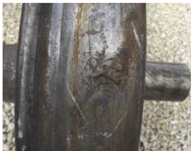
Модель дефекта — выщербина на поверхности катания глубиной до 8 мм и размером 36/17 мм
