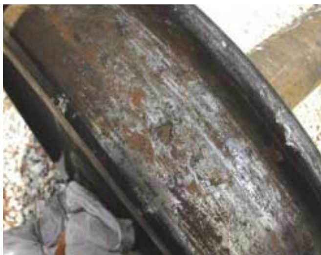
Модель дефекта — выщербина на поверхности катания глубиной до 3 мм и размером 15/10 мм
