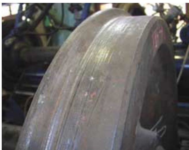
Модель дефекта — засерповка на поверхности колеса диаметром 7 мм и глубиной 3 мм
