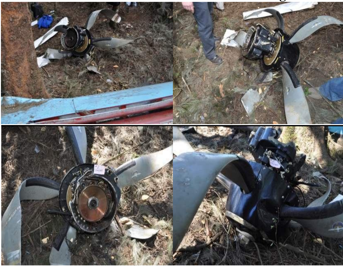
Hélice del motor derecho indicando energía
