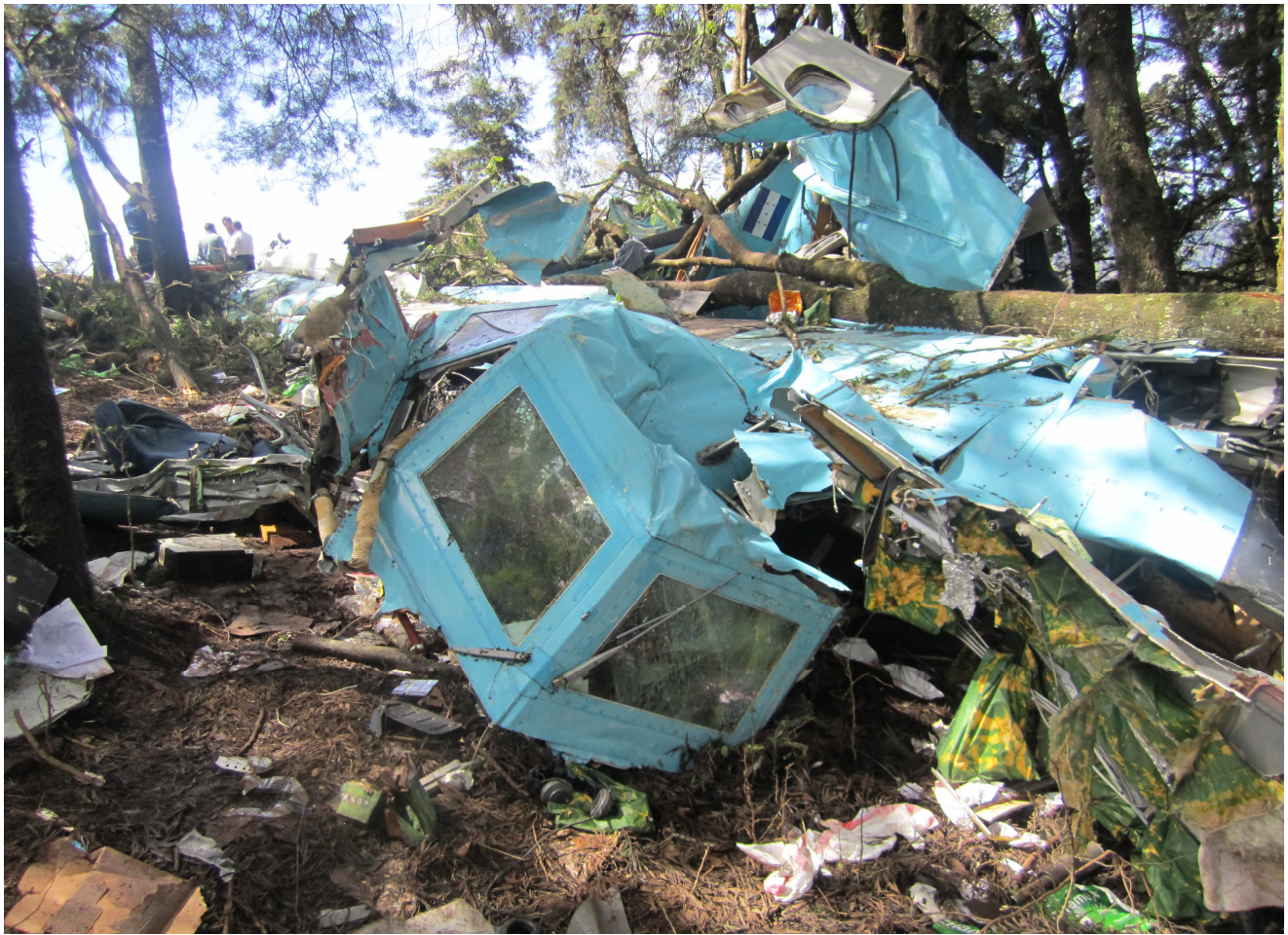
CABINA DE MANDO TOTALMENTE DESTRUIDA
